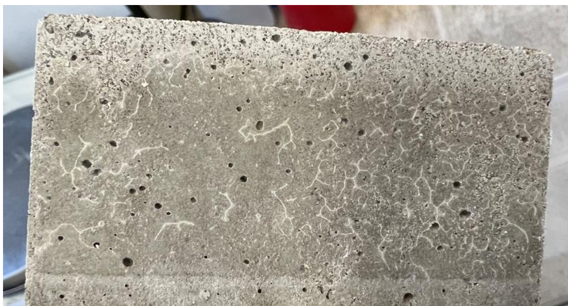
Obr. 29 – detail vzorku s krystalizací (K)
