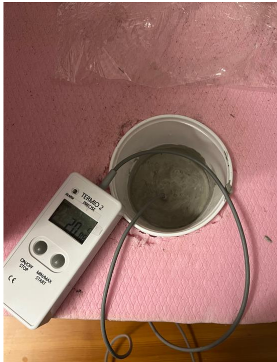
Obr. 37 – měřící soustava s teploměrem se sondou se záznamem teplot
