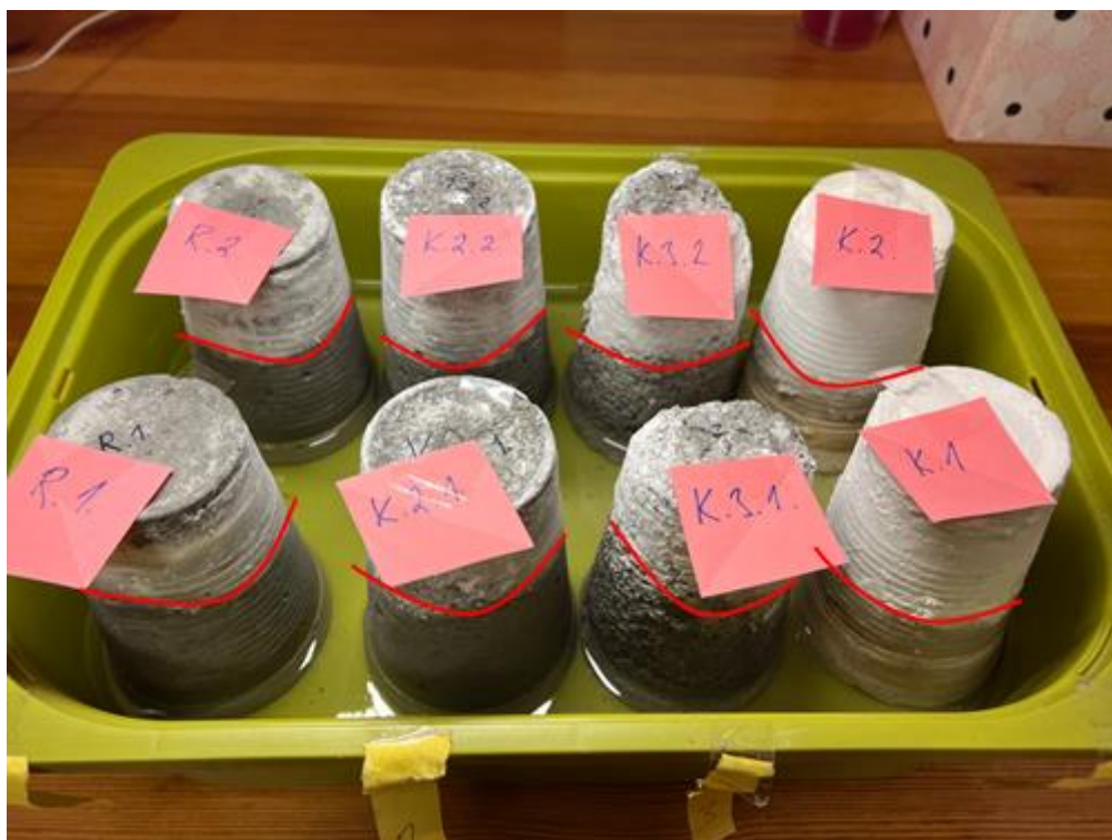
Obr. 13 – očištěné vzorky po šesti měsících po 24 hodinách ve vodě
