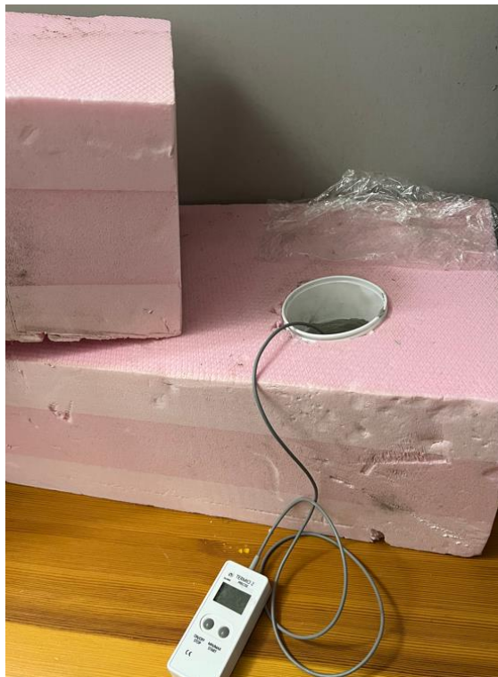
Obr. 36 – měřící soustava s teploměrem se sondou se záznamem teplot
