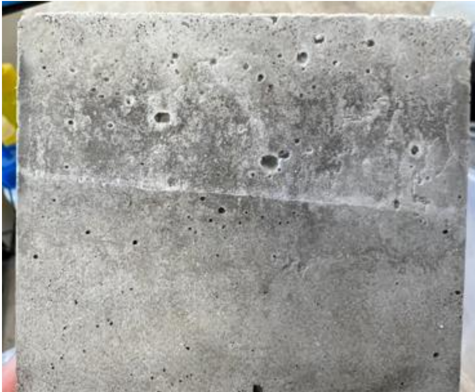
Obr. 30 – detail vzorku bez krystalizace (R)
