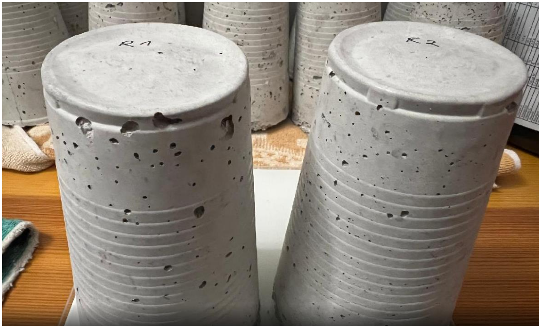
Obr. 21 – vzorky bez krystalizace po x dnech ve vodě
