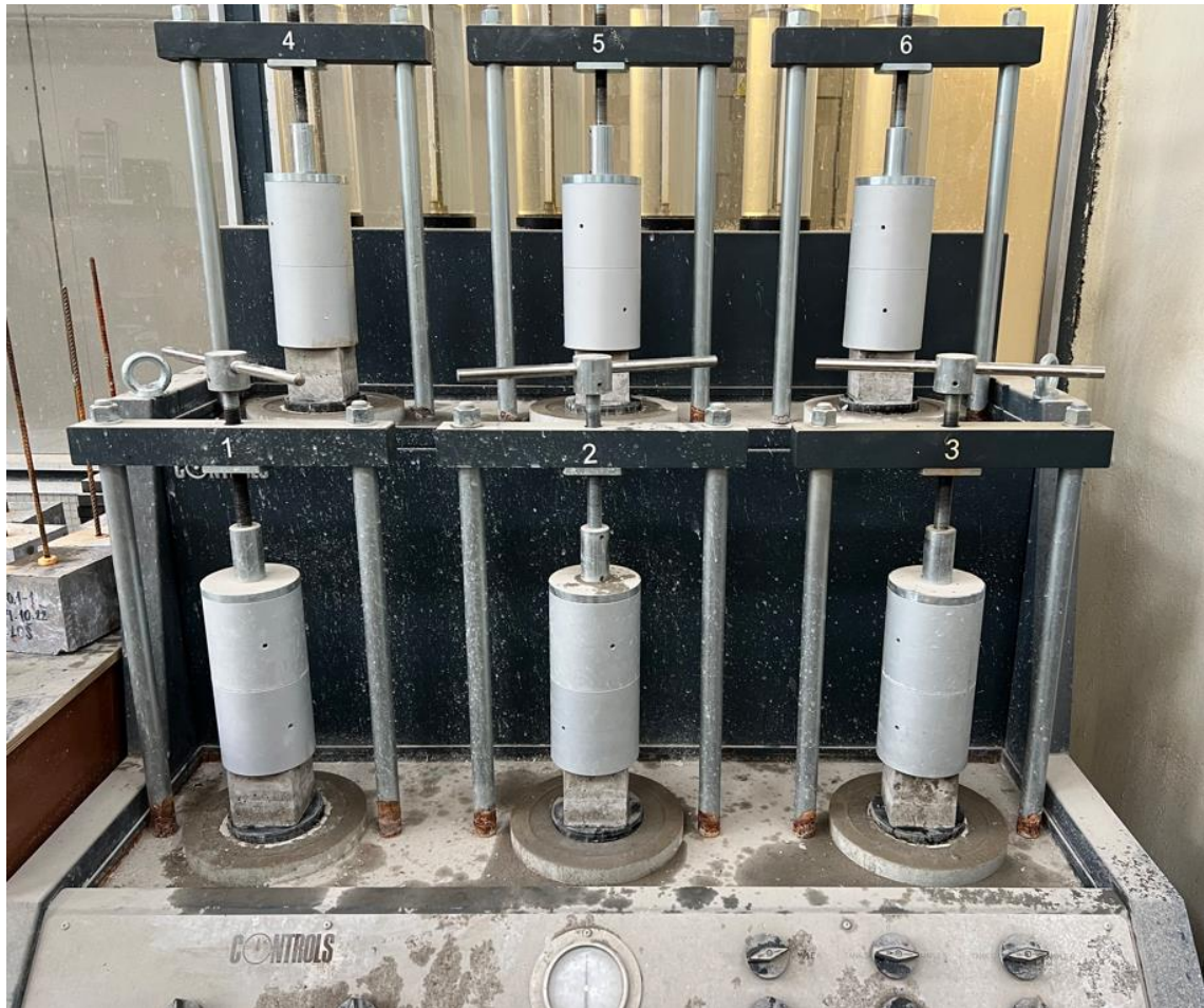
Obr. 41 – vzorky upevněné do vodotlačné stolice – začátek experimentu
