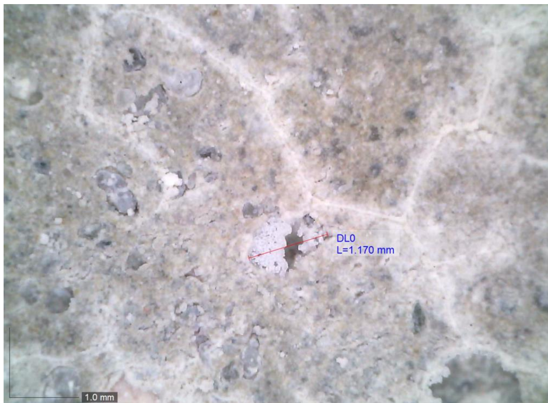
Obr. 31 – detail vzorku pod mikroskopem s krystalizací (K)
