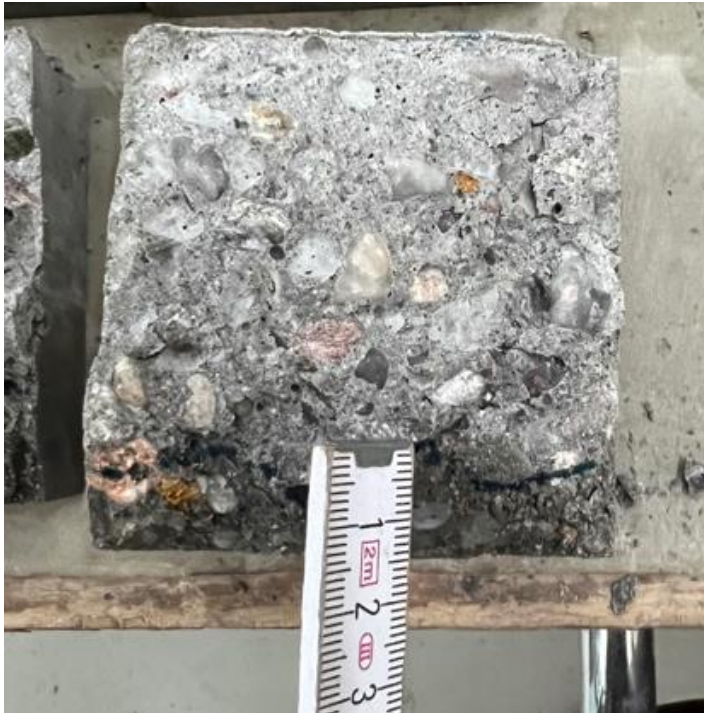
Obr. 42 – výsledný průsak vzorku K3
