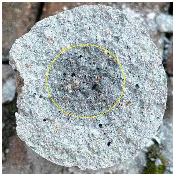
Obr. 17 – rozlomený vzorek s 2 \text{ kg/m}^3 krystalizace
