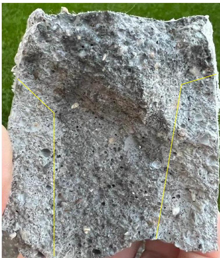
Obr. 18 – rozlomený vzorek s 3 \text{ kg/m}^3 krystalizace
