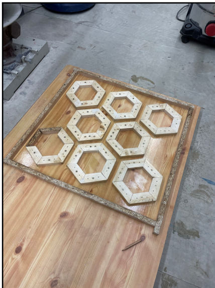
Obrázek 29: Připravená dřevěná rozebíratelná forma pro pokus č. 2
