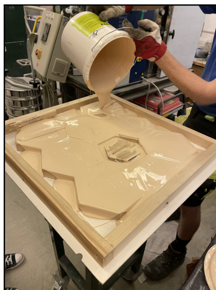
Obrázek 71: Proces vylévání formy na silikonovou formu pro prvek PRK č. 2
