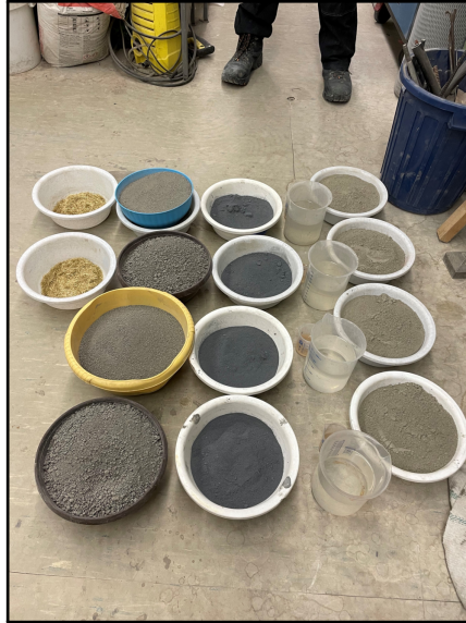
Obrázek 34: Navážený materiál pro betonáž pokusu č. 3
