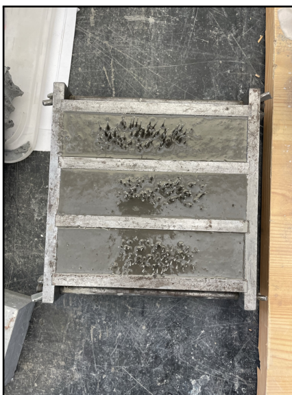
Obrázek 78: Forma „trojčata“ vybetonována betonem s optickými vlákny
