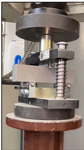
Obrázek 49: Zatěžovací soustava zkoušky pevnosti v tahu ohybem
