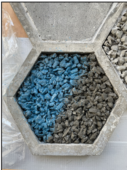
Obrázek 85: Mezerovitý beton s částí povrchu poprášným pigmentem
