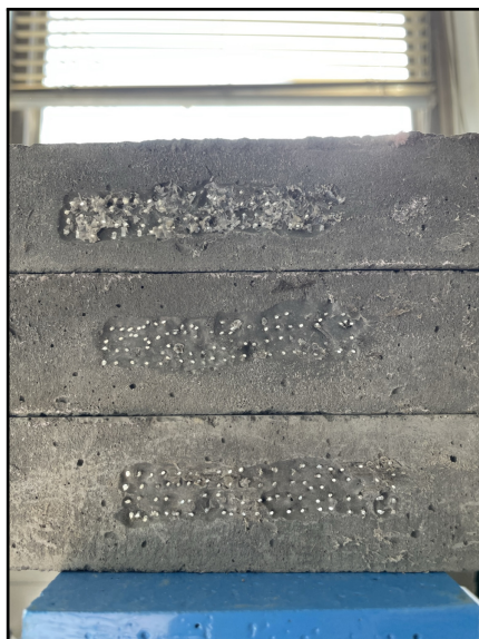
Obrázek 79: Betonové trámečky vzorků výplní s optickými vlákny prosvícené denním světlem
