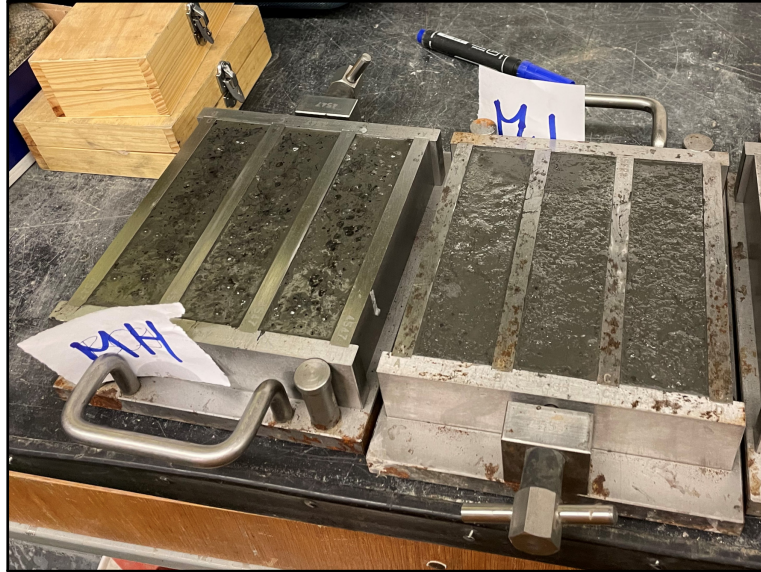
Obrázek 40: Vybetonované trámečky směsmi BS2-MJ a BS2-MH
