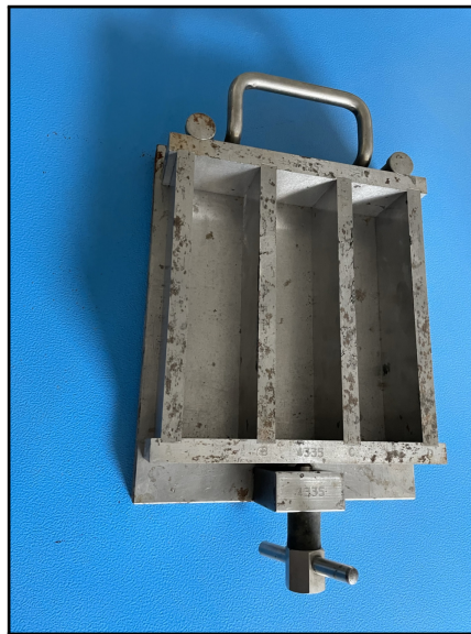
Obrázek 33: Použitá forma „trojče“ pro betonáž pokusu č. 3
