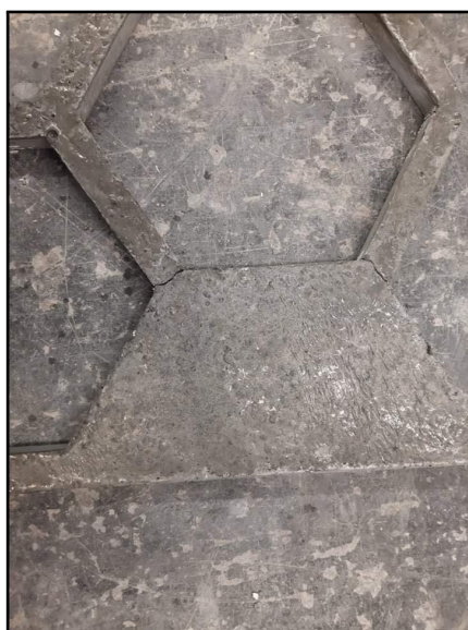
Obrázek 32: Rozsah trhlin ve vzorku P2.10
