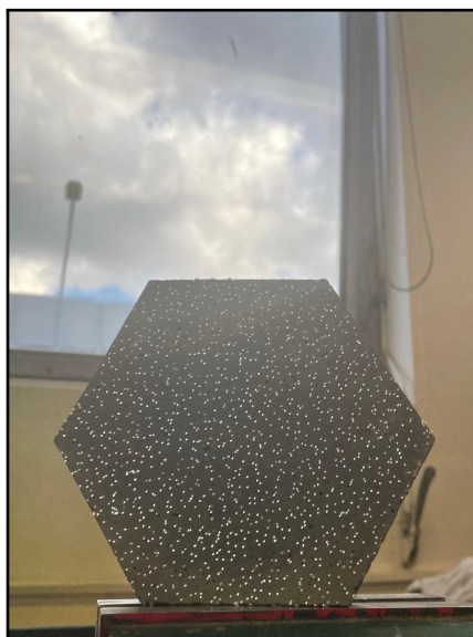
Obrázek 82: Výsledná výplň z průsvitného betonu po nařezání prosvícená denním světlem
