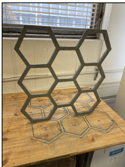
Obrázek 67: Prototyp rámové konstrukce č. 1 ve vzpřímené poloze bez vnějšího zatížení
