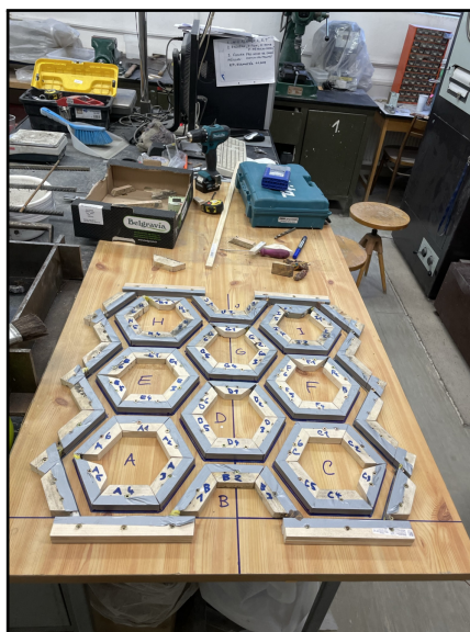
Obrázek 65: Připravená dřevěná forma k betonáži prototypu č. 1
