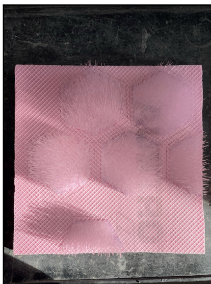
Obrázek 77: Připravená deska XPS se zapíchanými optickými vlákny
