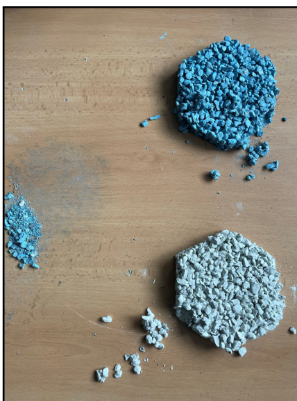
Obrázek 84: Mezerovitý beton s pigmenty a jejich rozpad
