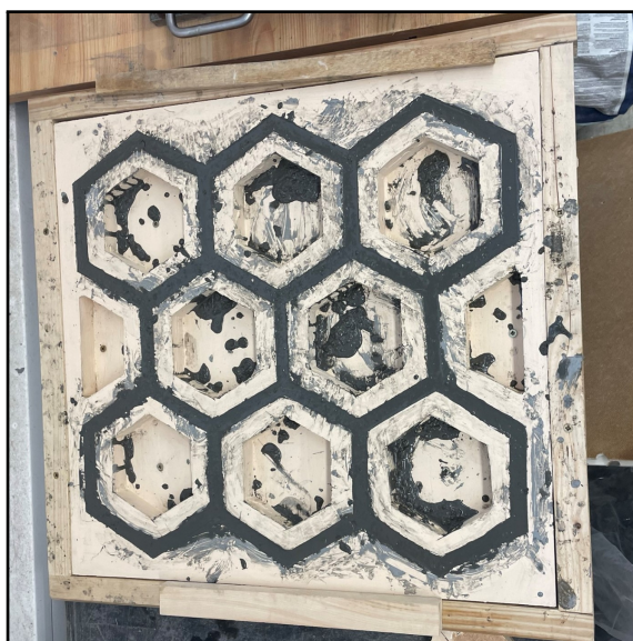
Obrázek 74: Vybetonovaný prvek PRK č. 2.1
