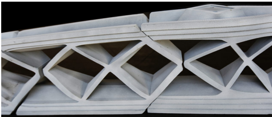
Obrázek 3.9: Část dodatečně předepnutého nosníku vytištěného z písku.[25]
