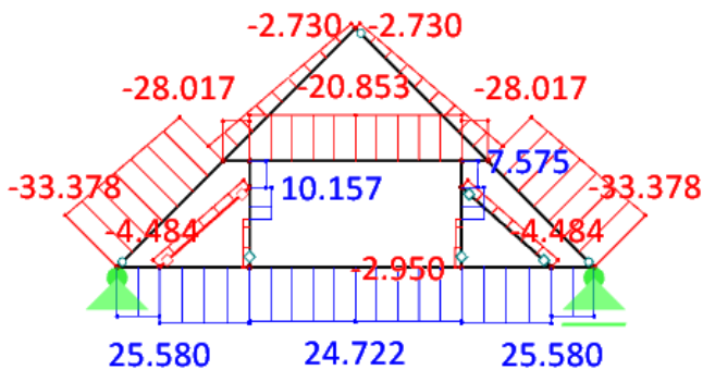
Obrázek 146: Rovinný model zohledňující poddajnosti spojů – podélná vazba - průběh normálové síly O5
