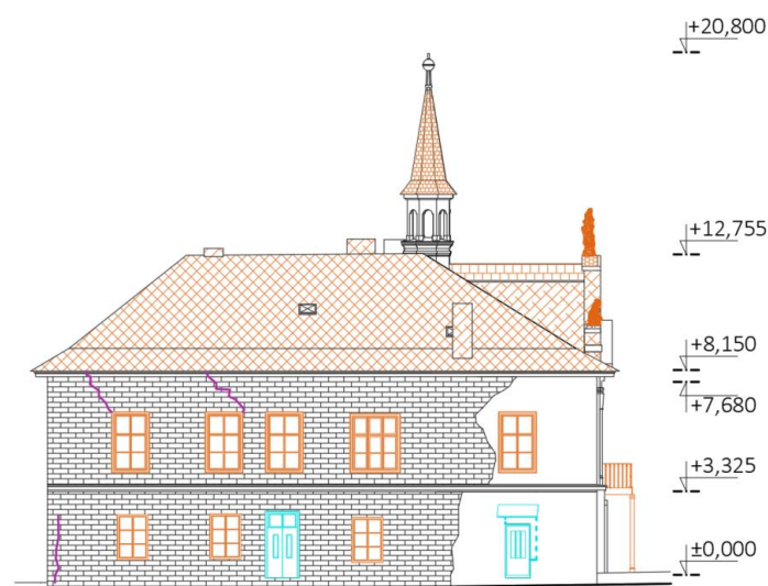
Obrázek 27: Západní pohled - stávající stav s vyznačenými poruchami (4)
