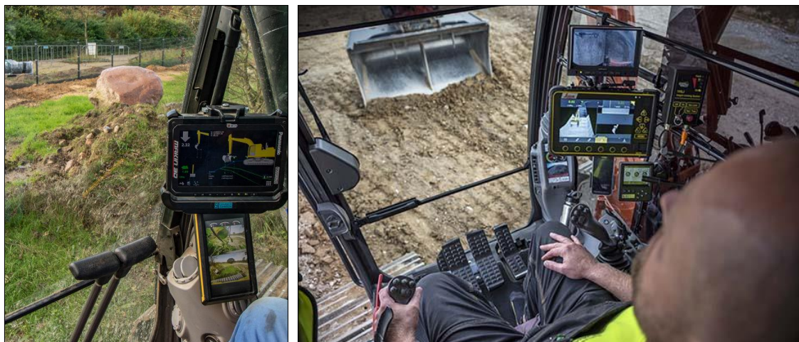
Obrázek 8.14: Navádění strojů pomocí nástrojů Makin 3D a Leica [47, 48]
