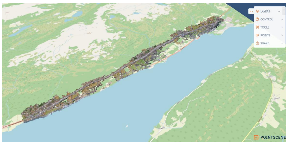
Obrázek 8.18: Model terénu zobrazený v nástroji Pointscene, který mapuje pomocí ALS technologie průběh výstavby [vlastní zpracování, 46]
