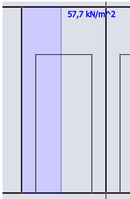
Obrázek 107: Průměrné smykové napětí ZS2 / 1000 / 700 / 4 na výšku
