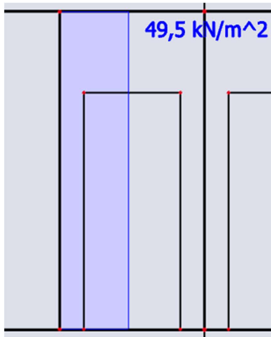
Obrázek 37: Průměrné smykové napětí ZS1 / 1000 / 700 / 6 na výšku stěny
