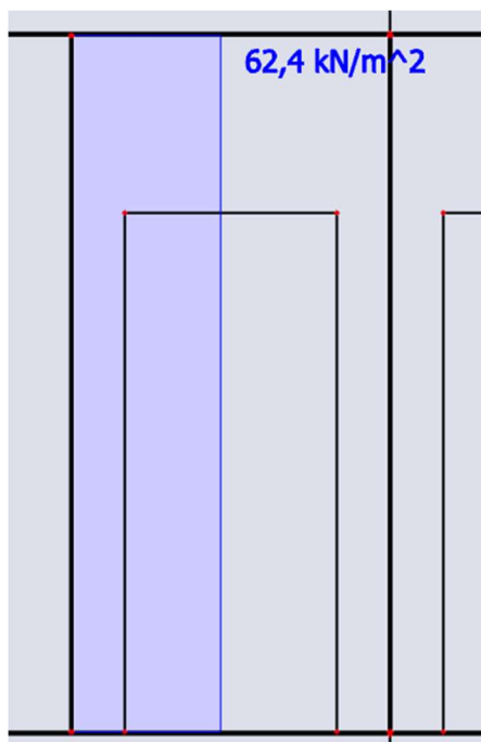
Obrázek 181: Průměrné smykové napětí ZS3 / 1000 / 700 / 4 na výšku
