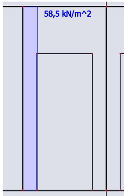
Obrázek 87: Průměrné smykové napětí ZS2 / 1000 / 200 / 6 na výšku stěny
