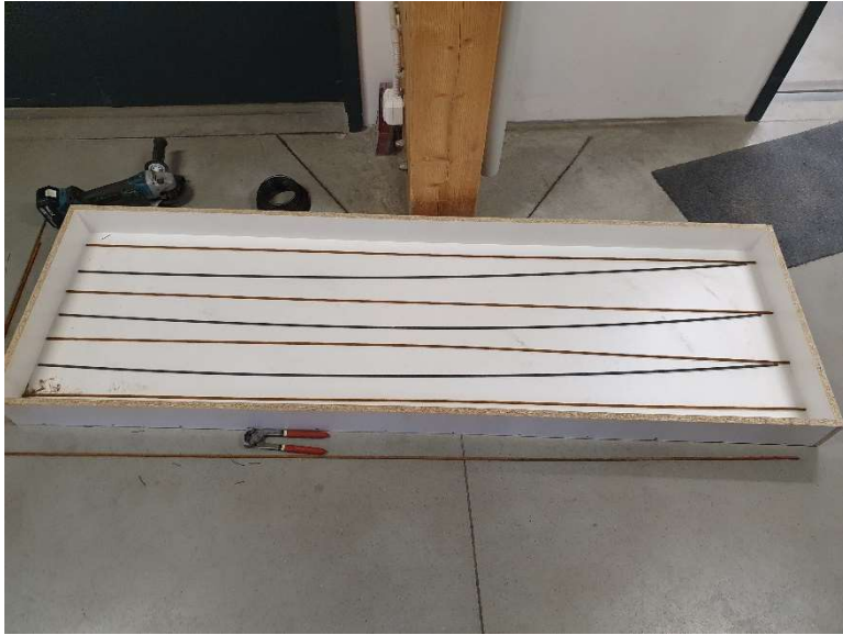
Obr. 28 – Foto nsvázané ocelové a čedičové výztuže
