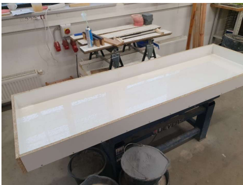
Obr. 26 – Foto formy na betonáž vzorku
