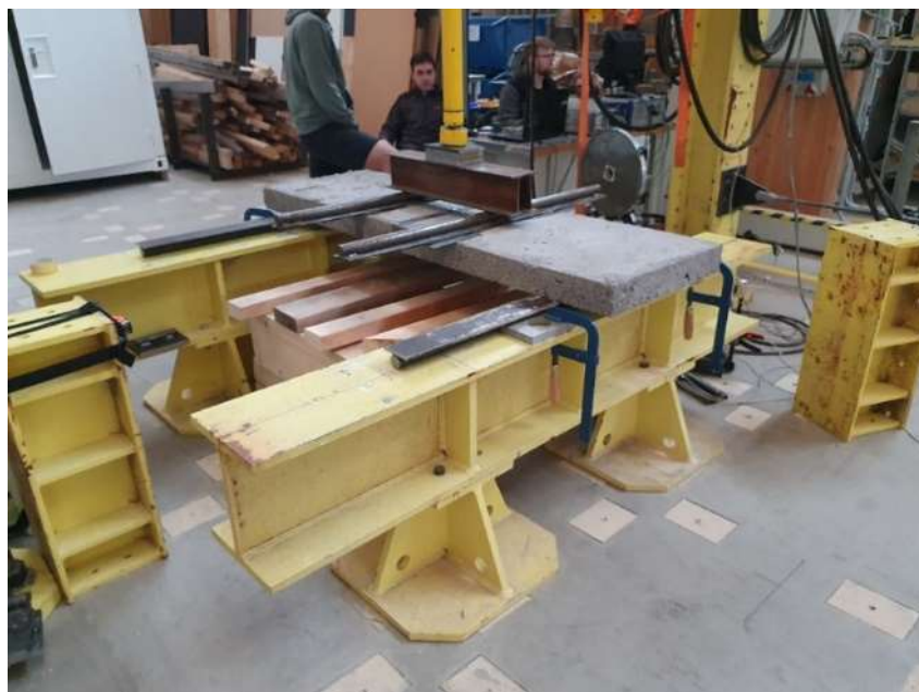
Obr. 35 – Foto panelu připraveného k destruktivní zatěžovací zkoušce
