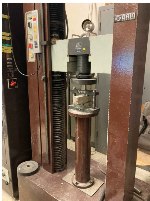
Obr. 4.12: Zkušební lis s ohybovým přípravkem
