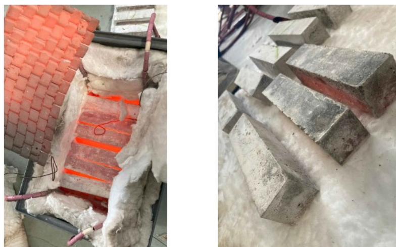
Obr. 4.10: Ocelová bedna po ukončení zahřívání (vlevo); Vyložená tělesa (vpravo)
