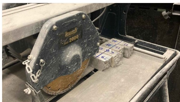
Obr. 4.23: Řezačka se zkušebními tělesy
