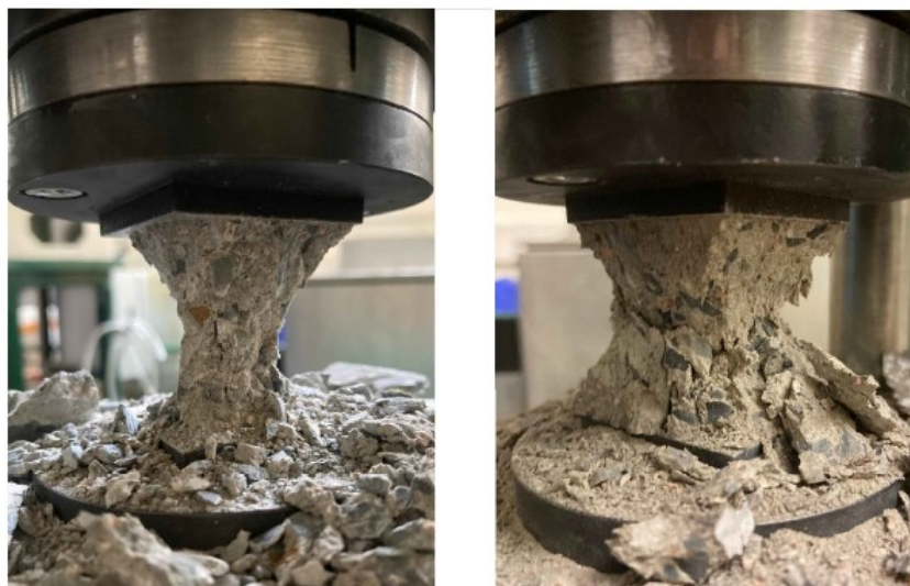
Obr. 4.17: Vyhovující způsoby porušení zkoušky pevnosti v tlaku
