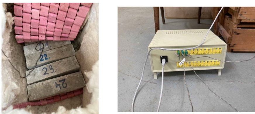
Obr. 4.8: Části zapojení pro měření teploty
