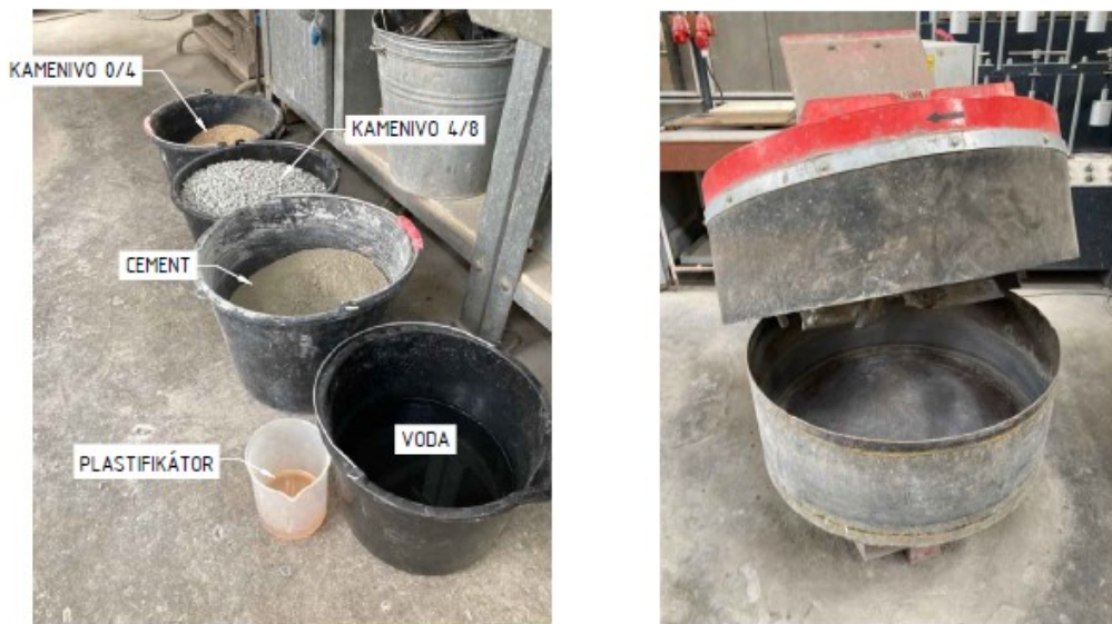
Obr. 4.2: Připravené složky betonové směsi (vlevo); Míchadlo (vpravo)
