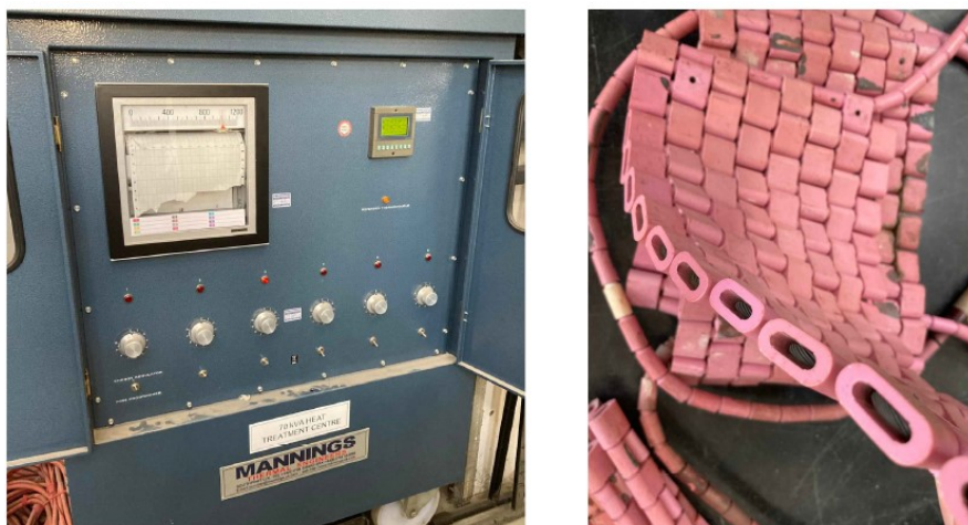
Obr. 4.6: Řídicí jednotka Manning (vlevo); Detail keramické topné podložky (vpravo)
