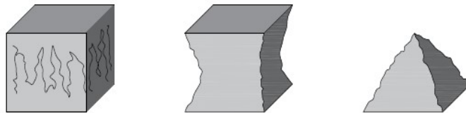
Obr. 3.6: Vyhovující způsoby porušení, převzato z [45]
