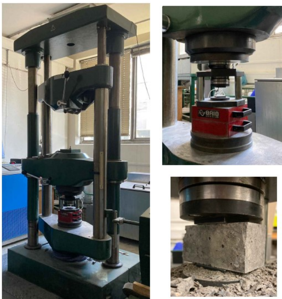
Obr. 4.16: Hydraulický lis (vlevo); Tlačný přípravek (vpravo nahoře); Zkušební těleso (vpravo dole)
