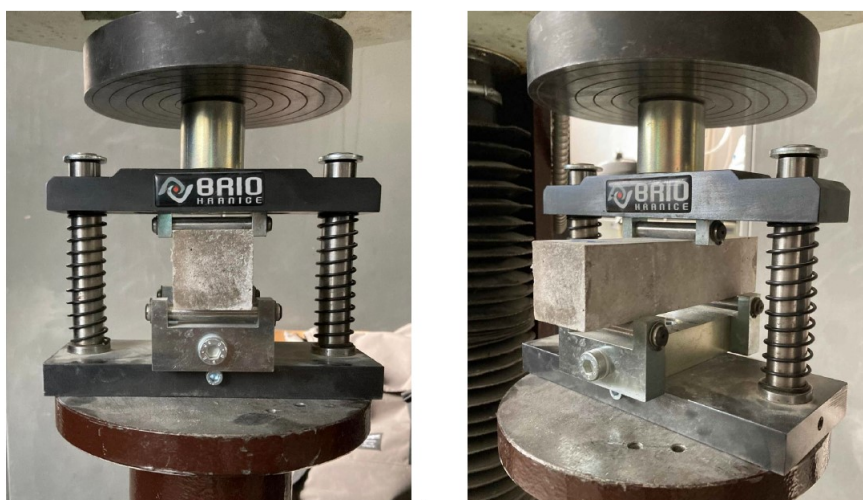
Obr. 4.13: Detail ohybového přípravku se zkušebním tělesem
