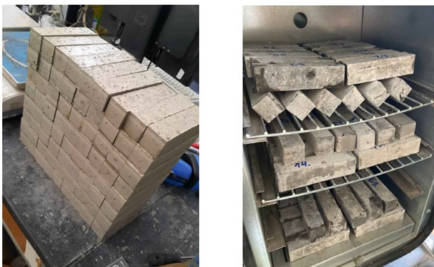
Obr. 4.4: Odbedněná tělesa (vlevo); Tělesa v sušicí peci(vpravo)
