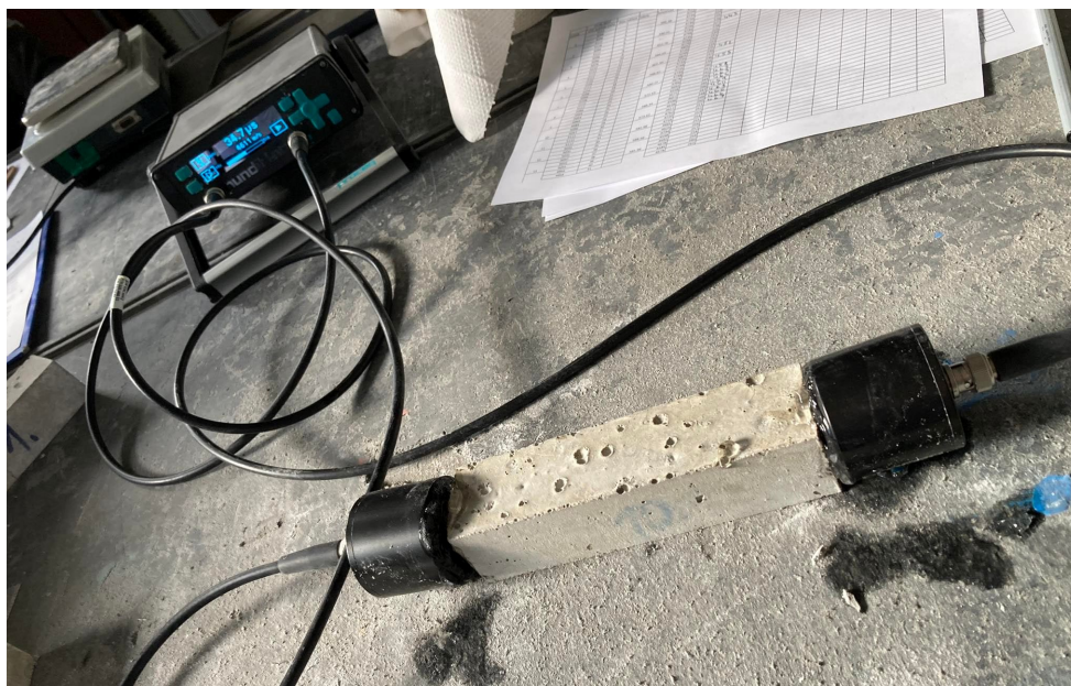
Obr. 4.20: UTZ impulsová zkouška
