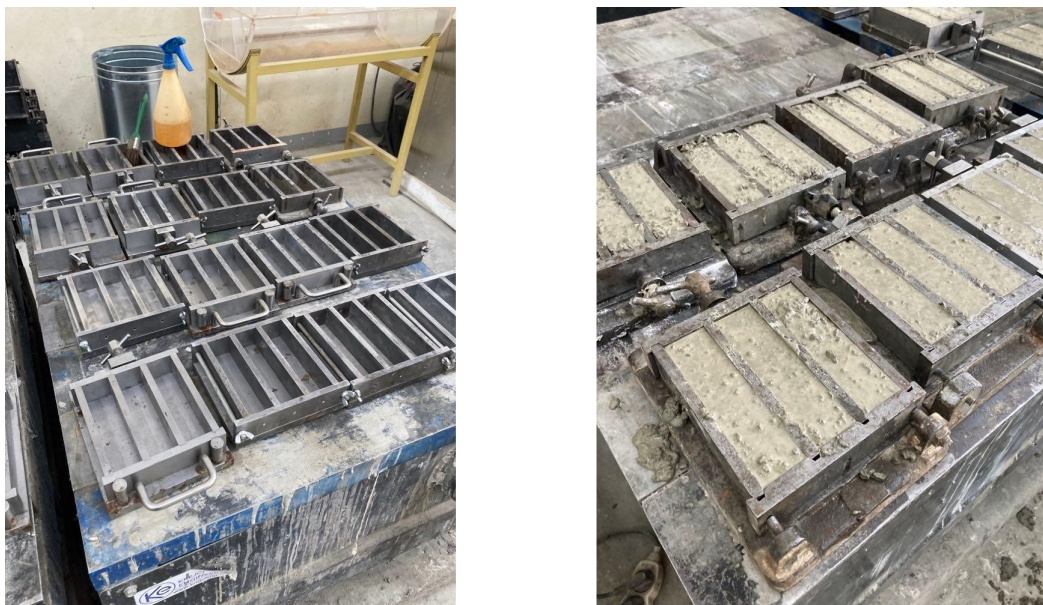
Obr. 4.3: Připravené bednění pro uložení betonové směsi (vlevo); Bednění po betonáži (vpravo)
