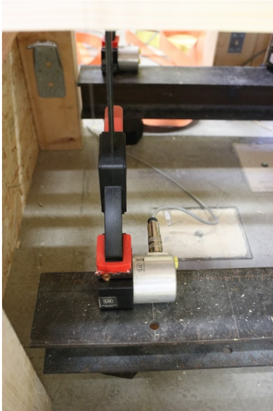
Obrázek 21: Umístění lankových WDS snímačů měřících svislý průhyb zkušebního tělesa
