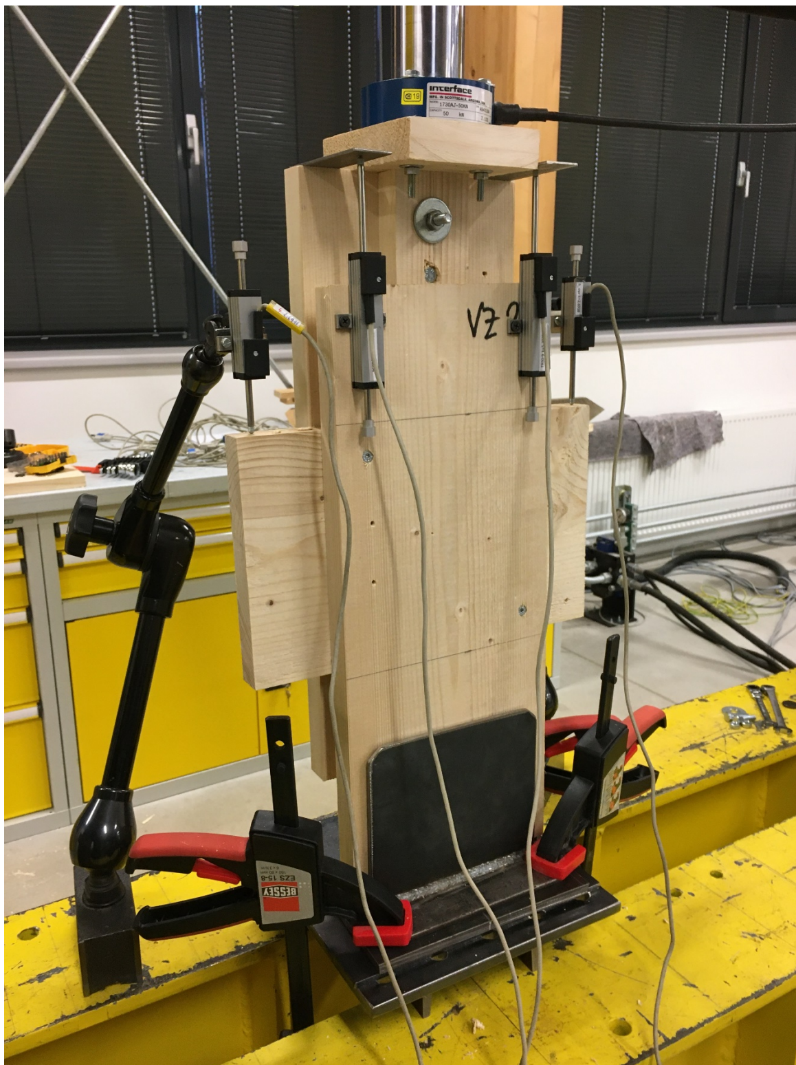
Obrázek 54: Uspořádání zkoušky v laboratoři; umístění snímačů TR25 k měření prokluzu střední příčné vrstvy a snímačů TR50 k měření prokluzu krajní vrstvy
