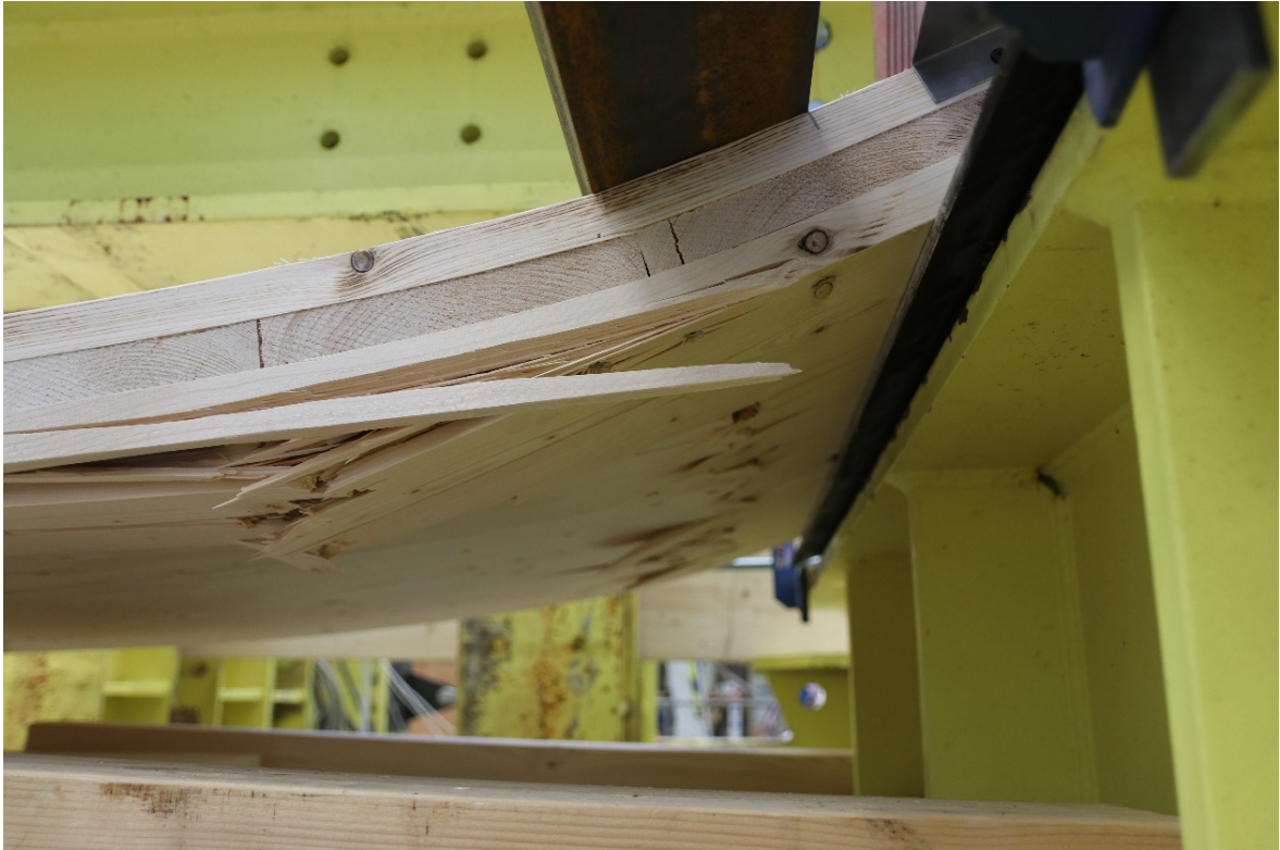
Obrázek 23: Ukázka porušení třívrstvého panelu
