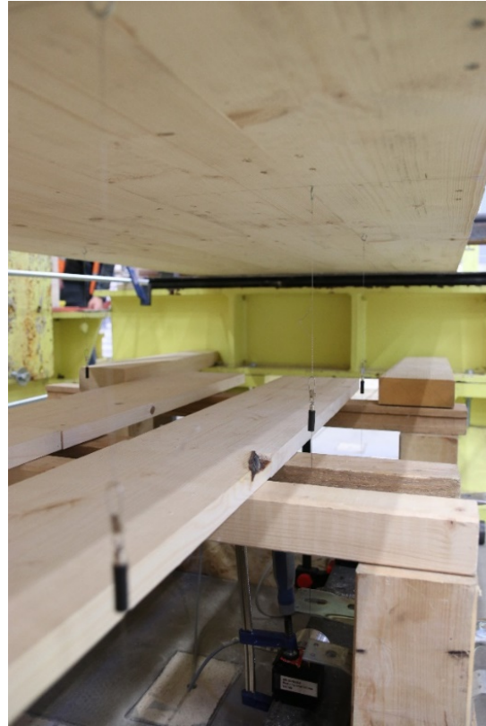
Obrázek 21: Umístění lankových WDS snímačů měřících svislý průhyb zkušebního tělesa
