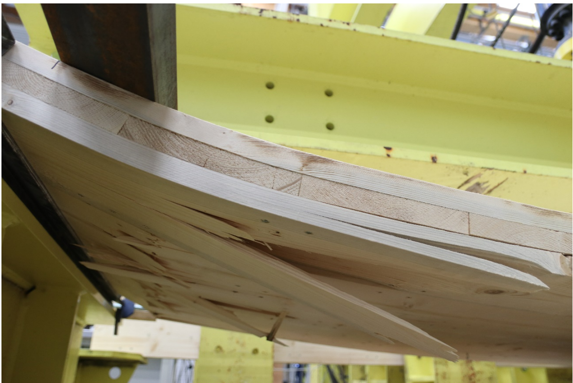
Obrázek 24: Ukázka porušení třívrstvého panelu
