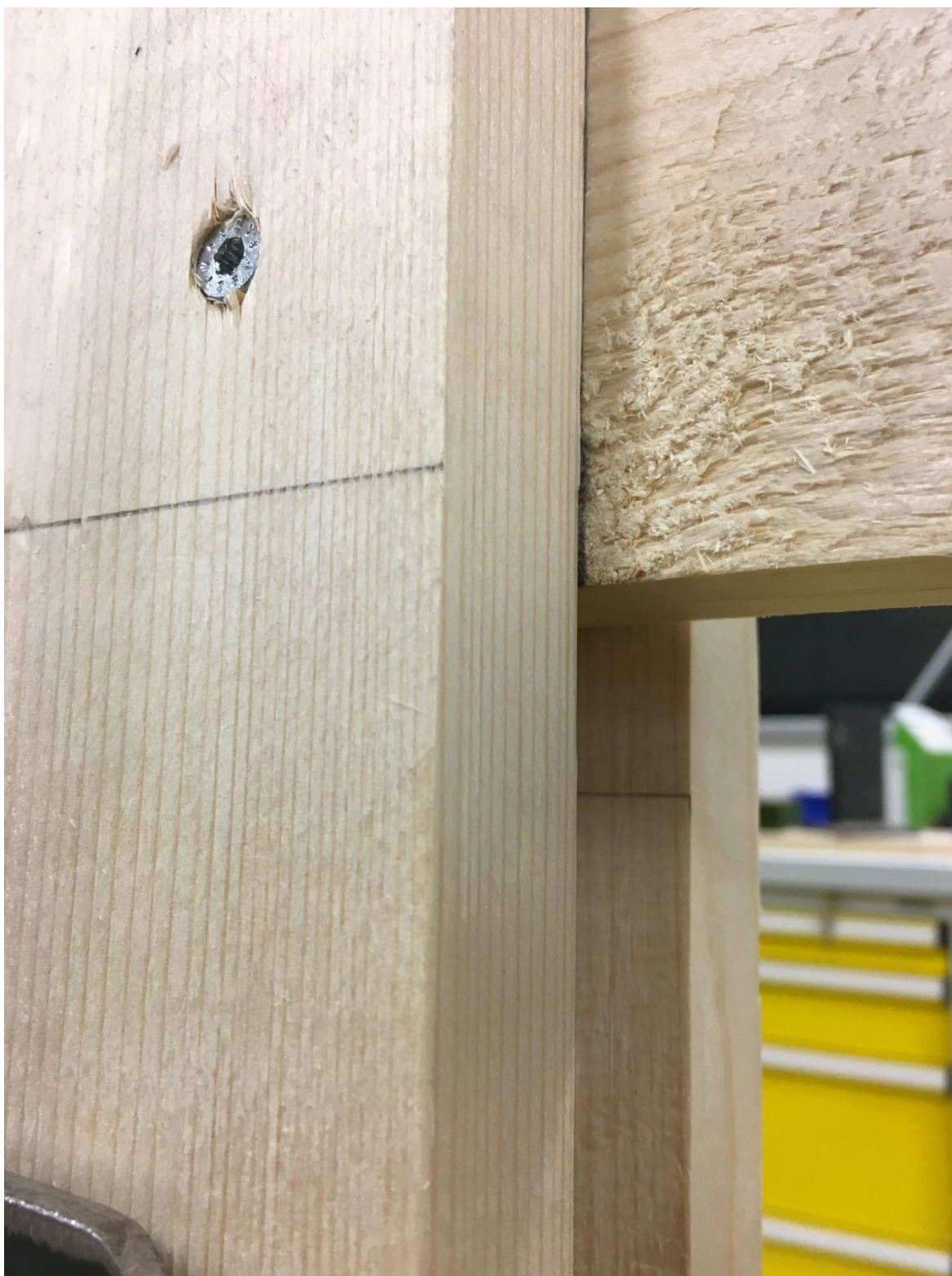
Obrázek 55: Porušený vzorek – linie nakreslené tužkou značí původní lícování vrstev vzorku. Na fotografii je vidět posunutí zadní podélné vrstvy, které je výrazně větší než posunutí střední vrstvy. Vytvoření plastického kloubu lze tedy očekávat mezi střední a zadní vrstvou.
