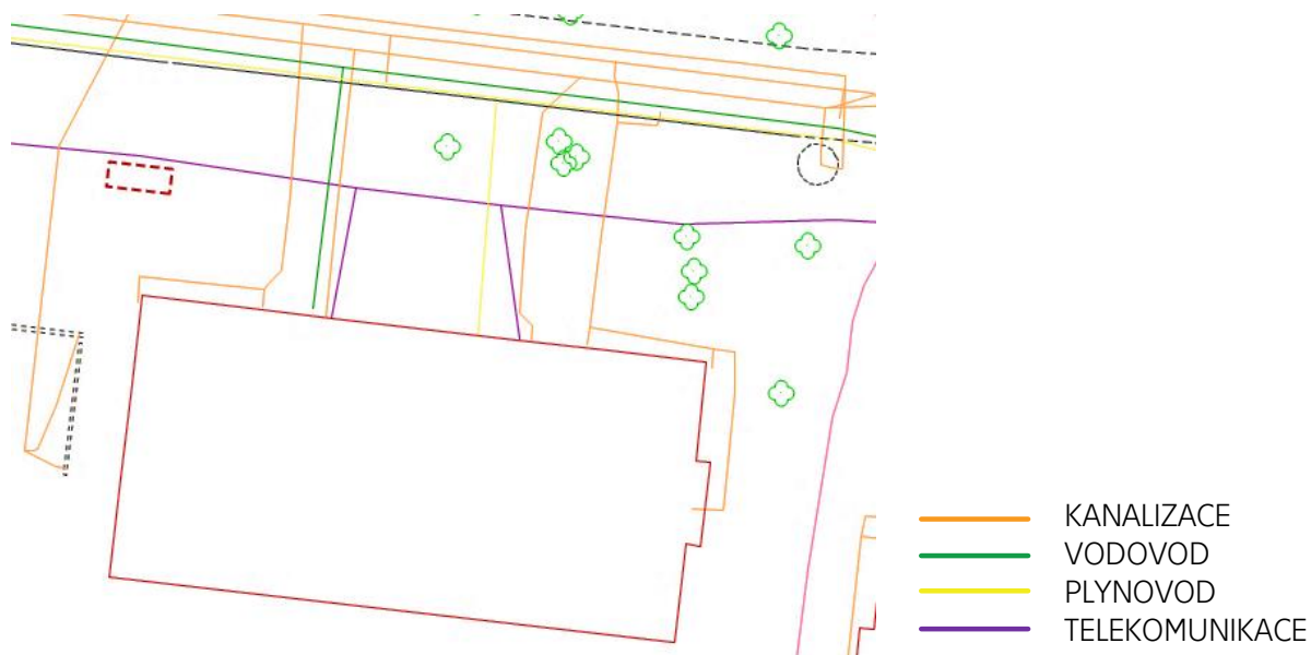
Obrázek 13 - Napojení objektu na inženýrské sítě [14]
