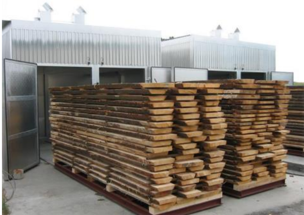
Obrázek 30 – Dřevěné fošny na kolovém vozíku [31]
