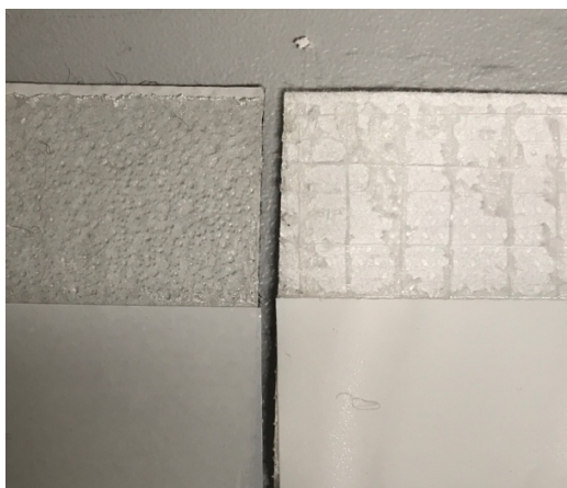
Obr. 32 Povrch lepidivé části pásek po odtrhové zkoušce (vpravo bílá, vlevo černá)
