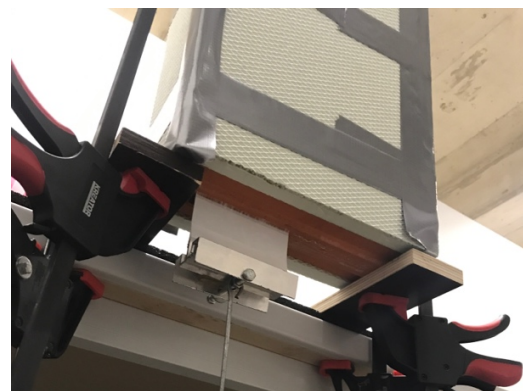
Obr. 29 Odrhová zkouška při zvýšené teplotě
