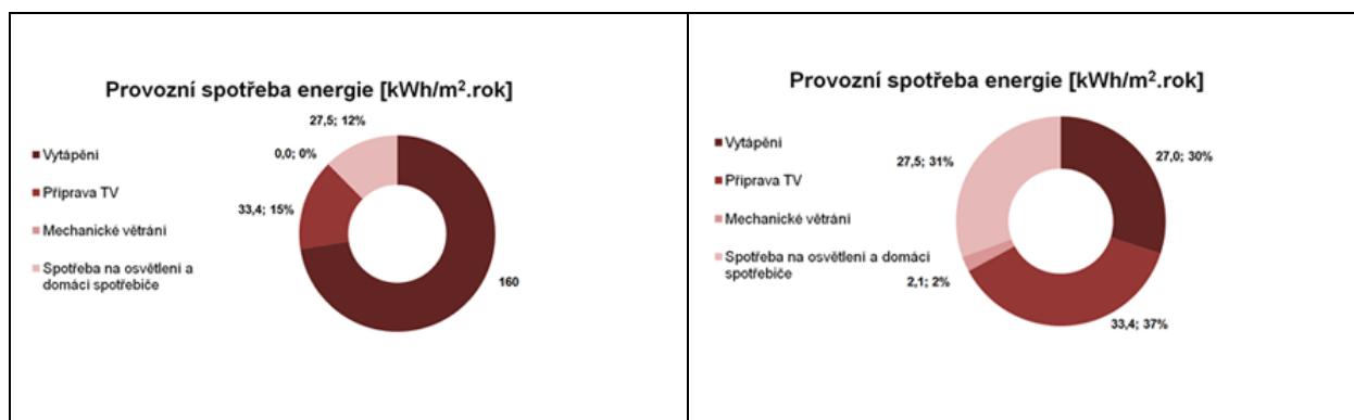
Obr. 1: Rozložení spotřeby energie v panelovém domě s nezateplenými konstrukcemi (vlevo) a v kvalitně zatepleném panelovém domě s izolovanými rozvody TV (vpravo). [1]
