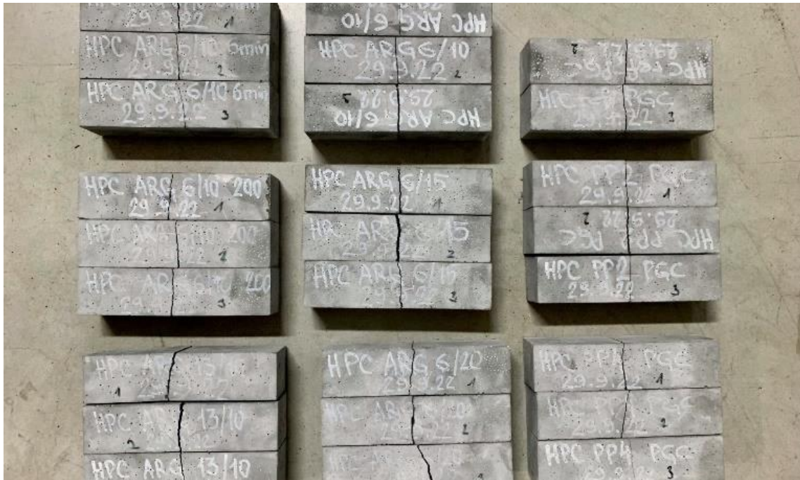
Obr. 5.11: Způsob porušení trámečků po zkoušce tříbodovým ohybem (skleněná i PP vlákna)
