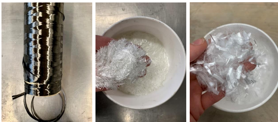
Obr. 4.2: Použité typy výztuže – zleva: Uhlíkové rovingy, skleněná vlákna, PP pazdeří
