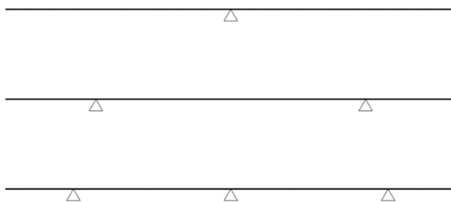
Obrázek 2.4: Statická schémata způsobů uložení příčníků trémových mostů
