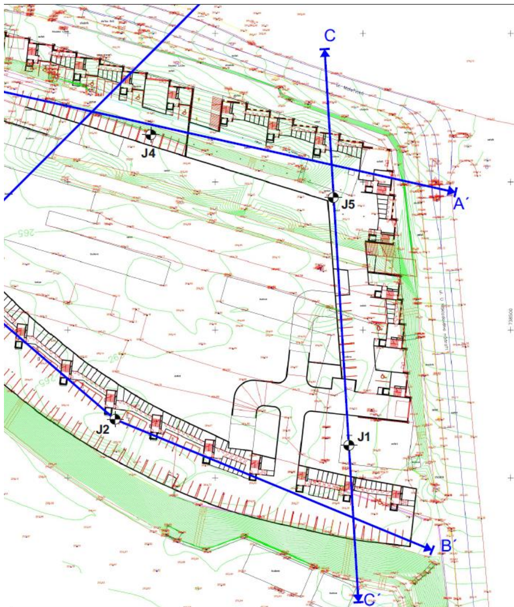
Obrázek 68: Situace sond se znázorněním řezů geologickým profilem
