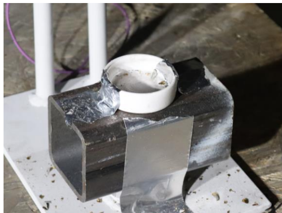
Obr. 41: Nádobka na hořlavinu vyvýšená, [21]
