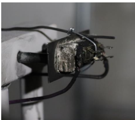
Obr. 33: Detail držáku bez pojistky E-bulb s termočlánkem, [21]
