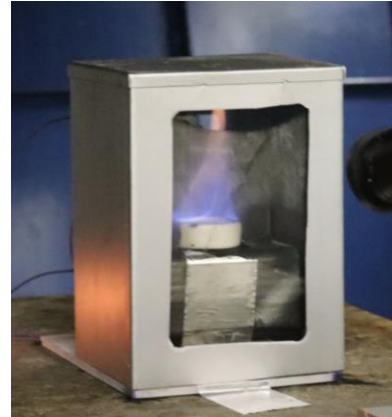
Obr. 49: Hoření pevného podpalovače, [21] Obr. 50: Hoření technického líhu, [21]
