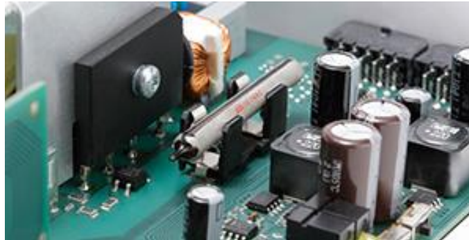
Obr. 29: E-bulb v elektrickém obvodu, [19]
