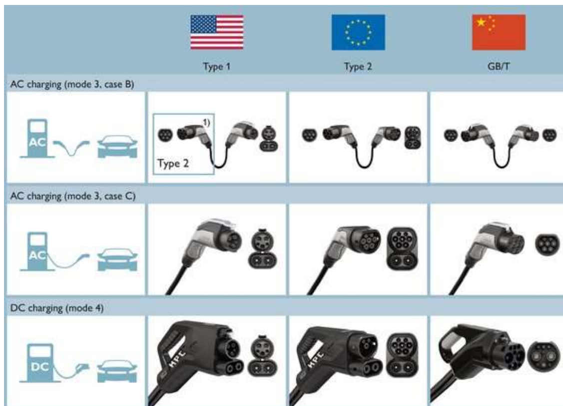
Obr. 2-9: Porovnání typů konektorů CCS v závislosti na nabíjecím režimu a oblasti použití – převzato z [18]
