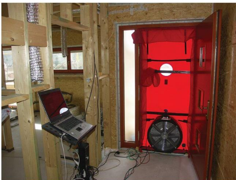
Obrázek 9, Blower – door test, Zdroj:[24]
