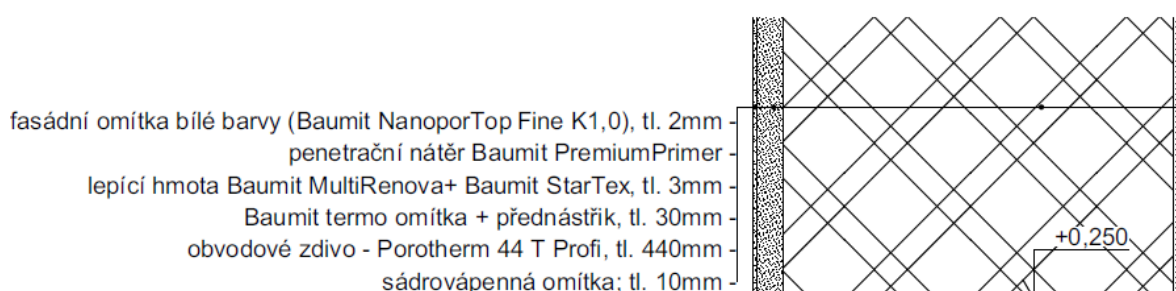
Obrázek 18 Detail konstrukce obvodového pláště
