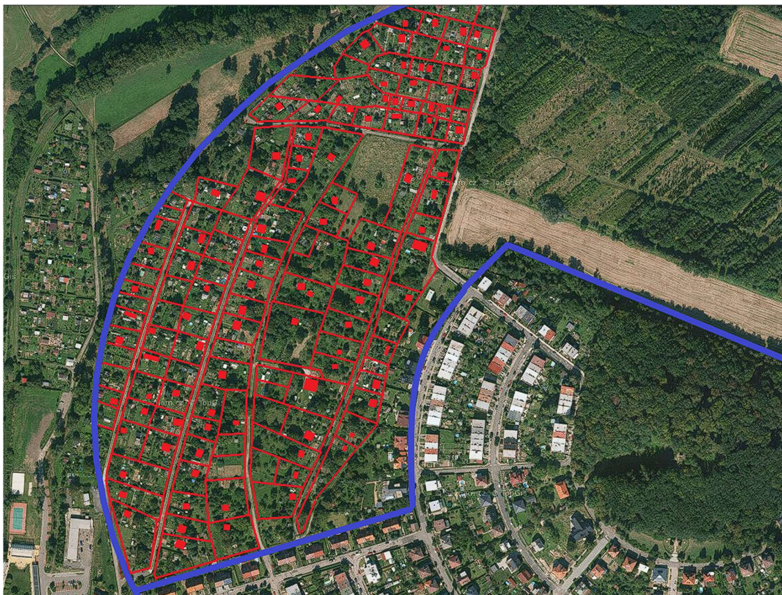
Obrázek 35 – výkres objektů k demolici, zdroj: vlastní tvorba
