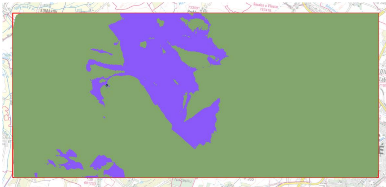
Obrázek 46: Části povrchu viditelné (fialová) a neviditelné (zelená) ze zadaného bodu pozorovatele
