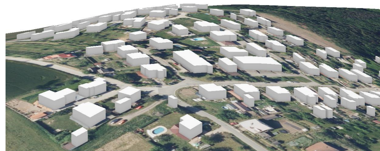
Obrázek 23: Vytažení budov metodou Rovnoměrná výška (9,5 m)
