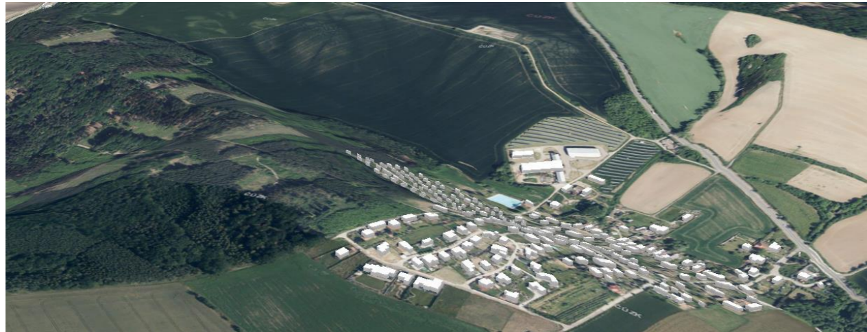
Obrázek 24: Výřez modelu terénu s „nadrapovanou“ ortofoto mapou ČR a jednotně zdviženými budovami
