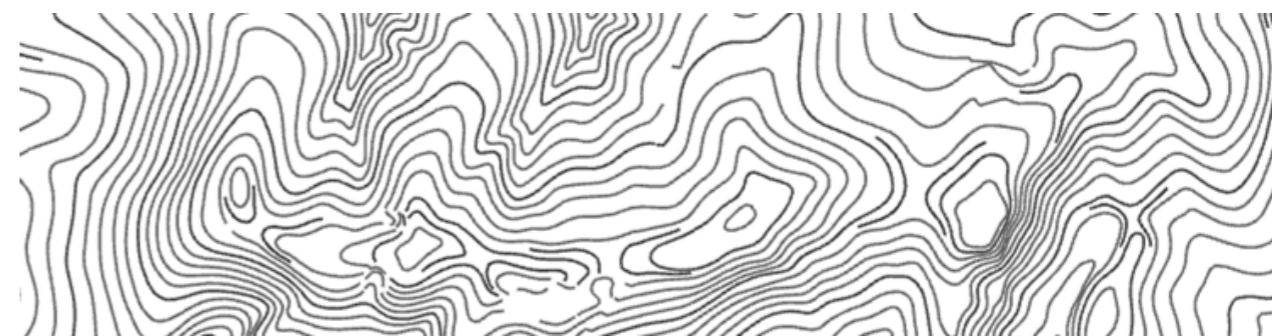
Obrázek 11: Soubor vrstevnic (základní, zesílené, doplňkové) ze ZABAGEDu, v kroku 2 m
