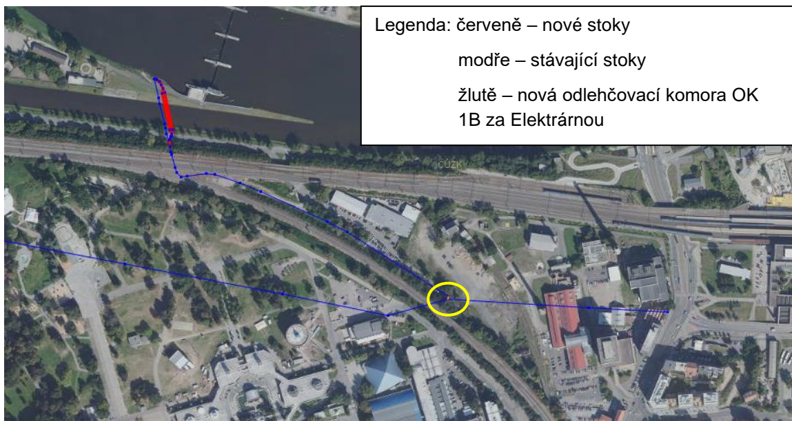
Obrázek 51 Zkapacitnění přelivu na OK 1B Za elektrárnou
