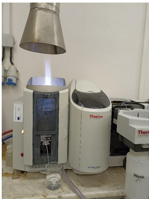
Obrázek 20 a 21: FAAS, s pohonem směsi oxidu dusného a acetylenu, vlevo – bez vzorku, vpravo – se vzorkem, foto: Lenka Langhammerová (9.11.2022)
