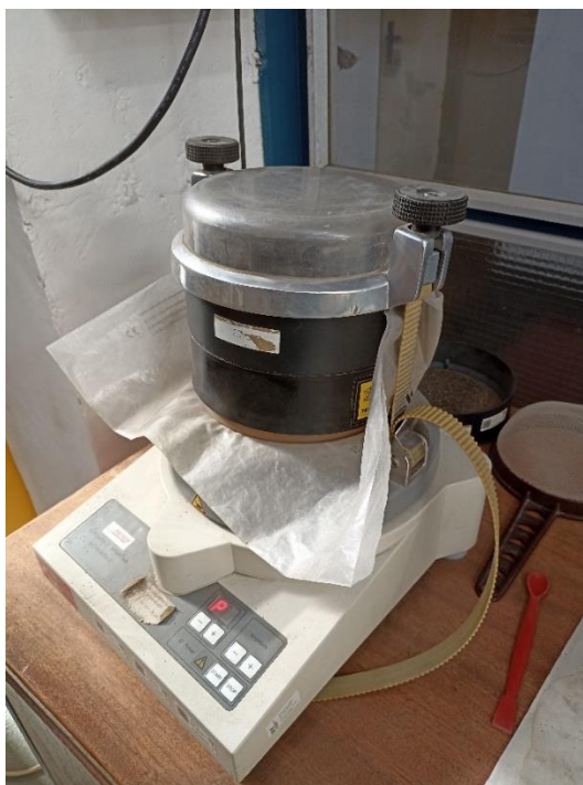
Obrázek 16: Sítování vzorku na analytických sítích s nylonovou tkaninou, foto: Lenka Langhammerová (10.10.2022)
