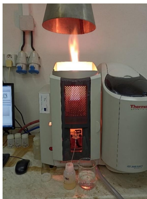
Obrázek 20 a 21: FAAS, s pohonem směsi oxidu dusného a acetylenu, vlevo – bez vzorku, vpravo – se vzorkem, foto: Lenka Langhammerová (9.11.2022)
