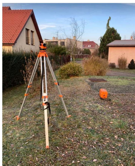
Obrázek 26 - Sestavený nivelační přístroj na OK-Tahiti
