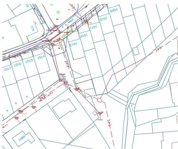
Obrázek 25 - Chyba polohy sítě v passportu kanalizace
