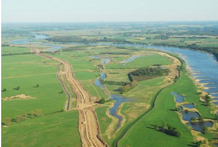
Obr. 2 – Přírodě blízké protipovodňové opatření (ochranná hráz posunuta od toku a území zanecháno jako přírodní poldr), (Střední Čechy – ochrana přírody)
