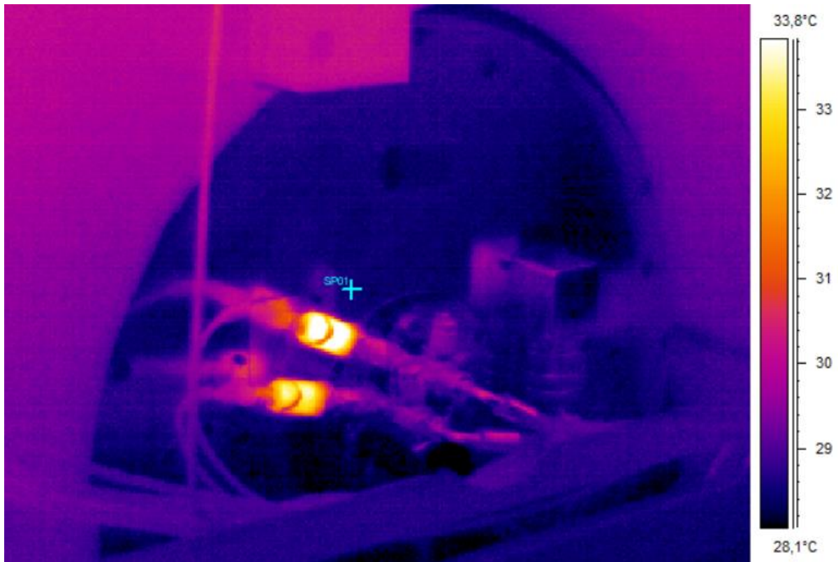
Obrázek 25 Snímek termokamerou - Torque motor osy A
