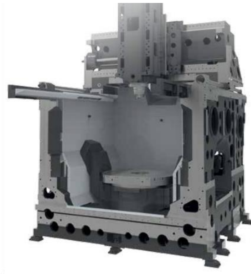
Obrázek 23 Nosná struktura MCU 700 - pohony os [19]
