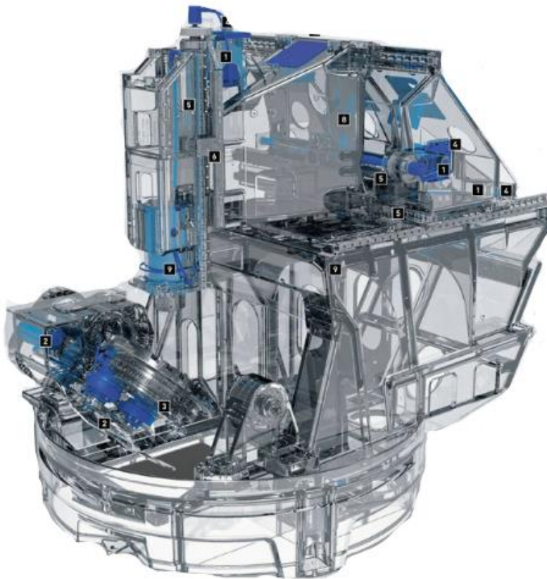
Obrázek 4 Chlazení stroje DMU monoBLOCK [3]
