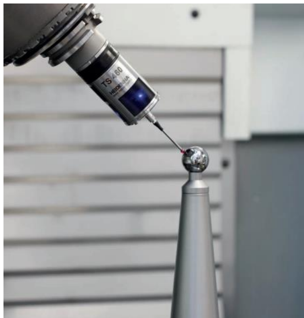
Obrázek 14 Dotyková sonda Hidenhain TS 460, artefakt KKH 250 [8]
