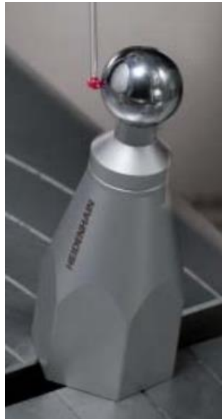
Obrázek 27 Měřící artefakt - Heidenhain KKH 100 [20]
