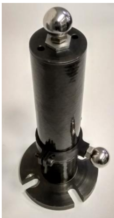
Obrázek 26 Měřicí artefakt - ložiskové kuličky na karbonovém podstavci
