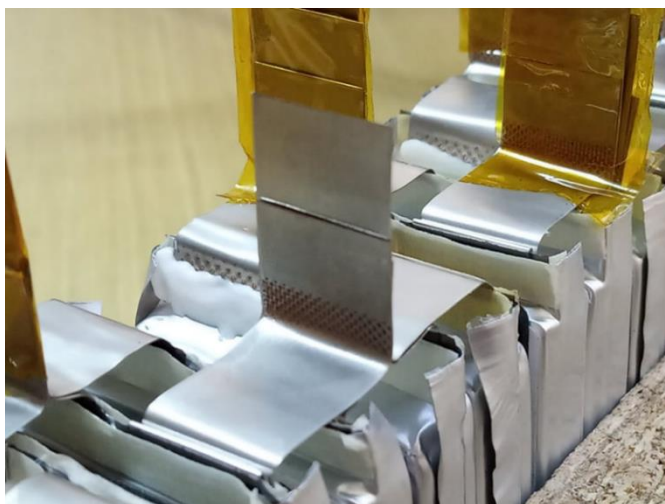
Obrázek 10.1 Propojení 4 plechů ultrazvukový svarem
