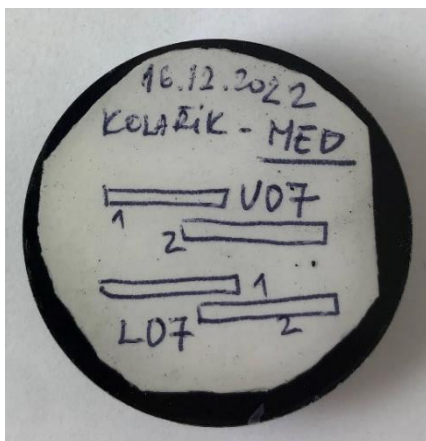
Obrázek 14.3 Metalografický vzorek zadní strana s pojmenovanými částmi
