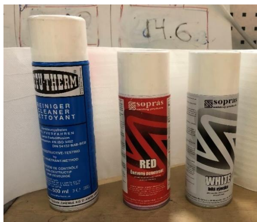
Obrázek 13.2 Pomůcky potřebné pro realizaci kapilární zkoušky metodou barevné indikace
