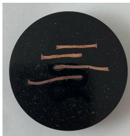
Obrázek 14.4 Metalografický vzorek přední (zkoumaná) strana
