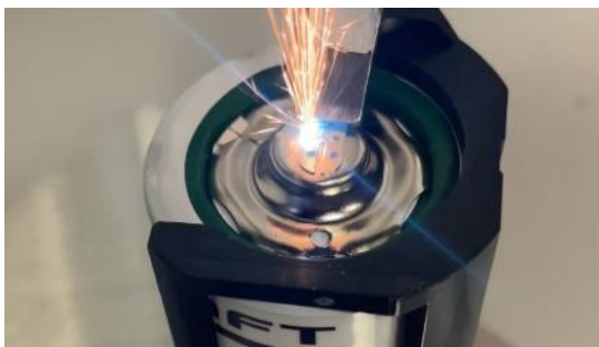
Obrázek 5.12 Svařování niklových pásků k bateriovým cylindrickým článkům [27]
