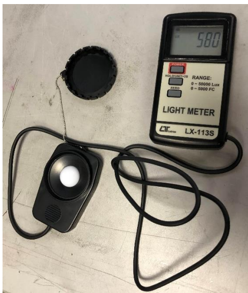
Obrázek 13.1 Měření intenzity osvětlení pomocí Luxmetru Light meter LX-113S
