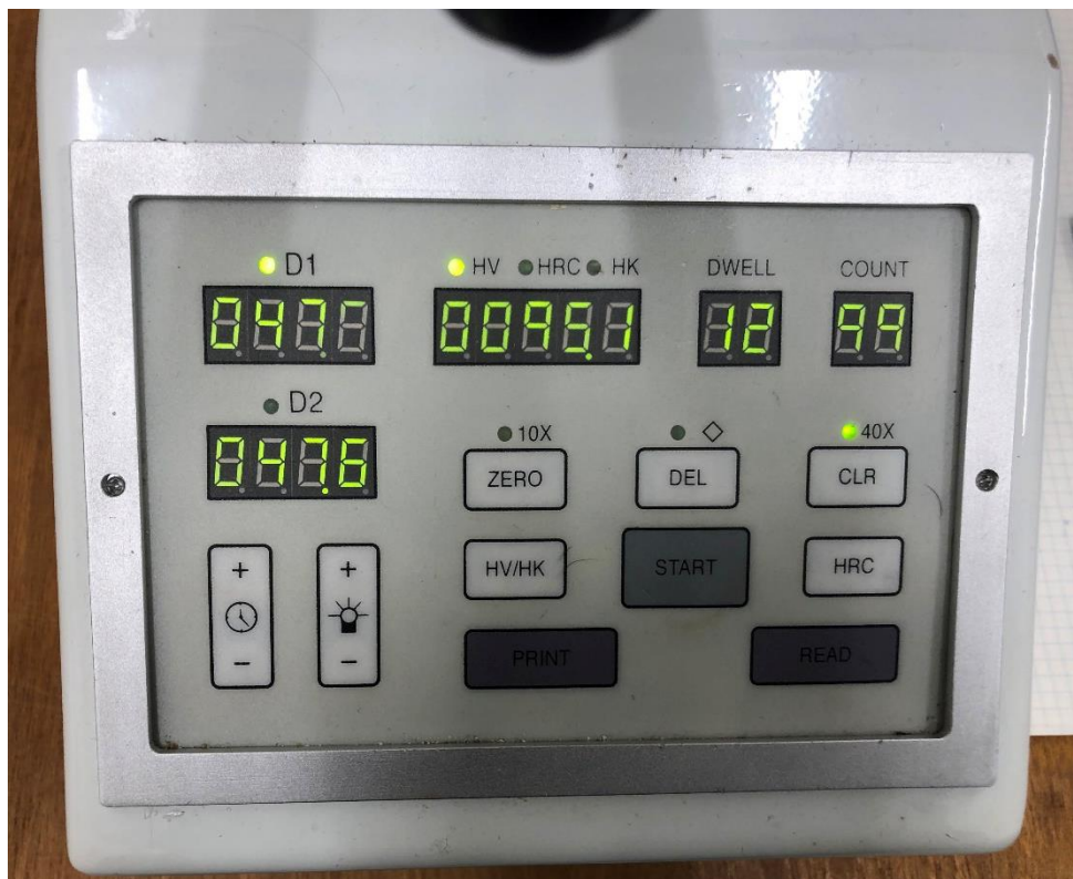
Obrázek 14.18 Tvrdoměr – ovládací deska, základní nastavení a číselné hodnoty výsledků
