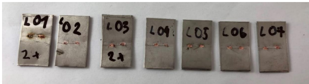
Obrázek 12.7 Výsledné svařené vzorky ručním laserovým svařováním L01 – L07
