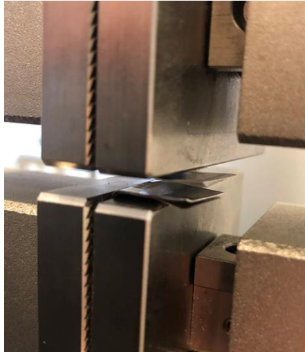
Obrázek 14.12 Střih ultrazvukového svaru
