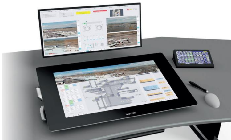
Obrázok 20 Integrated Controller Working Position (iCWP) vyvíjaný spoločnosťou Frequentis [45]
