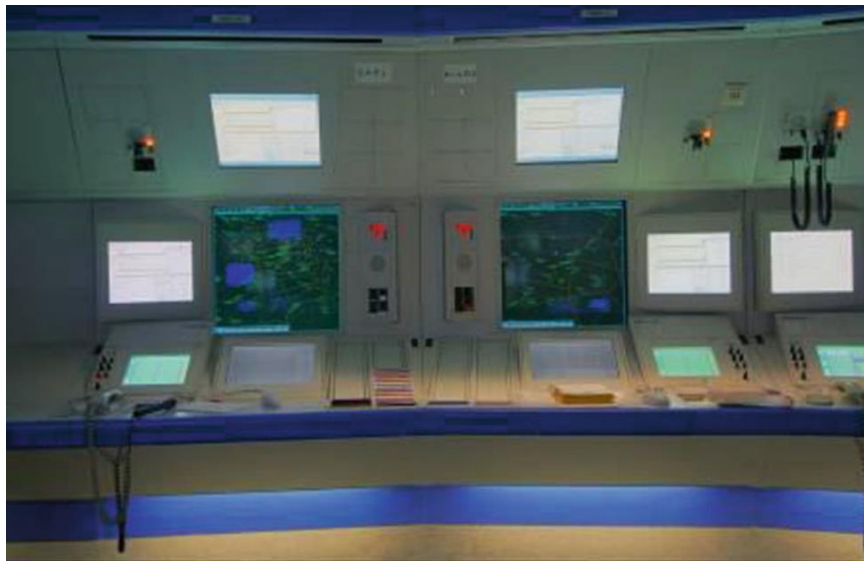
Obrázok 2 Traťová stanica typu P1/ATCAS používaná poskytovateľom letových služieb v Nemecku Deutsche Flugsicherung (DFS) [3]
