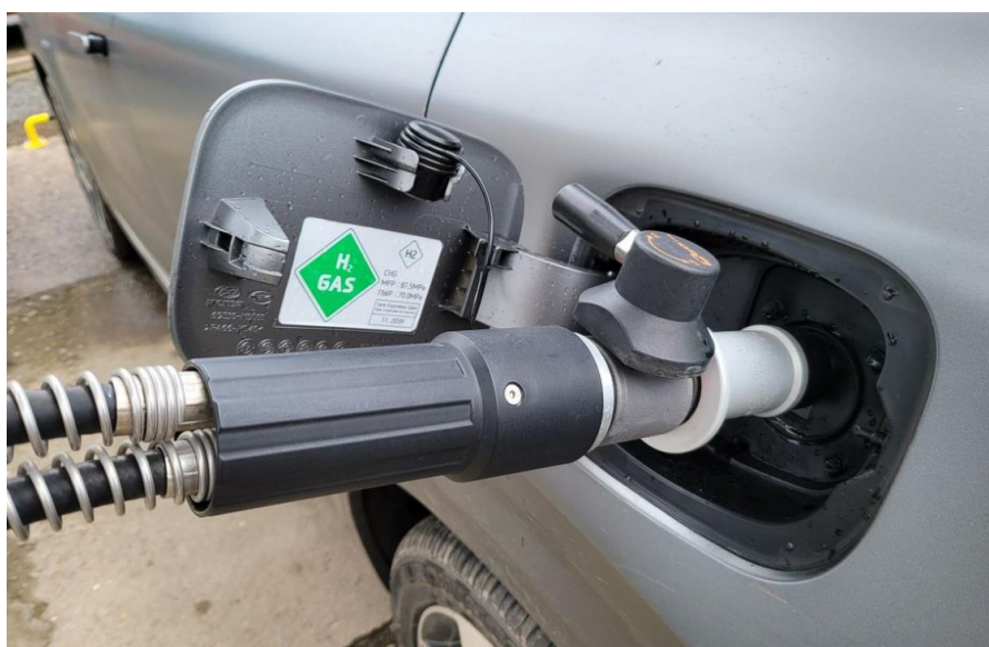
Obr. 16 – Plnění stlačeného vodíku
