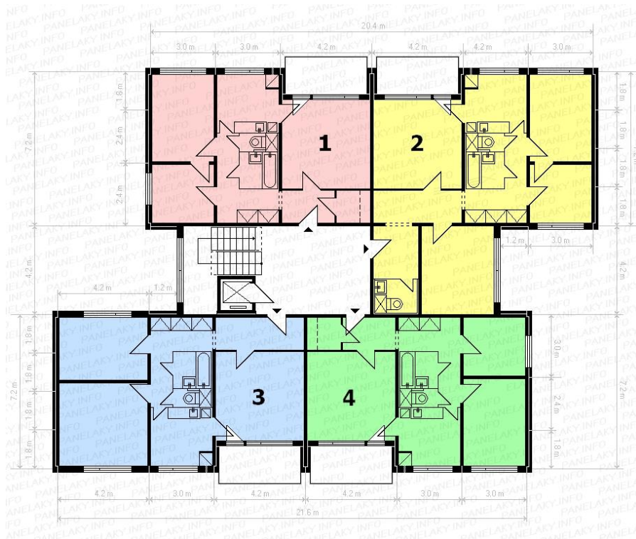
Obrázek 17: Půdorys panelového OP 1.11 [31]
