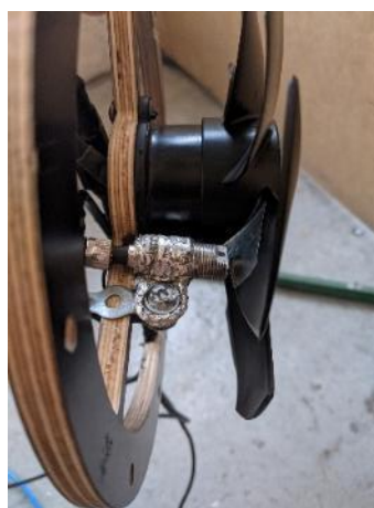
Obr 56 Detail snímače otáček
