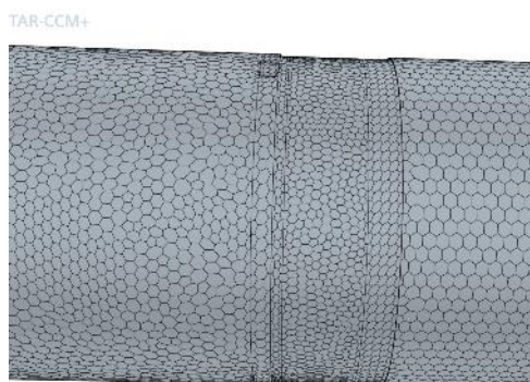
Obr 81 Povrchová síť - metoda tlakového spádu
