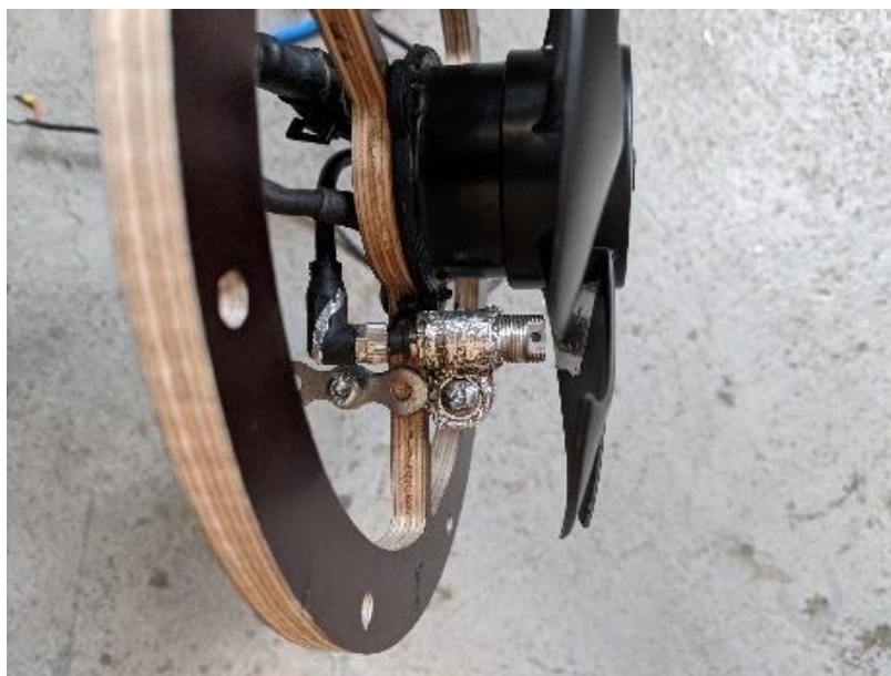
Obr 57 Detail uchycení snímače otáček
