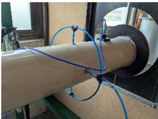
Obr 45 Tlakový odběr celkový pohled
