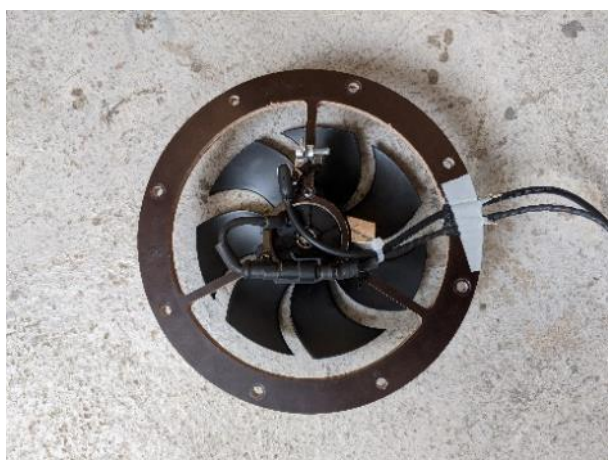
Obr 55 celkový pohled na snímač otáček
