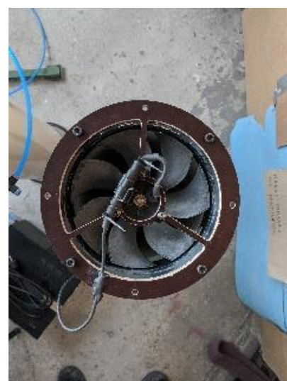
Obr 126 Detail uchycení ventilátoru
