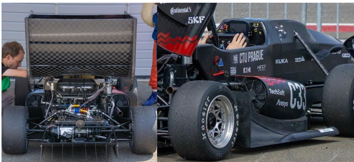
Obr 3 Symetrické umístění ventilátorů
