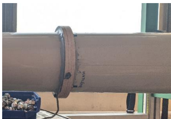
Obr 41 Detail uchycení ventilátoru
