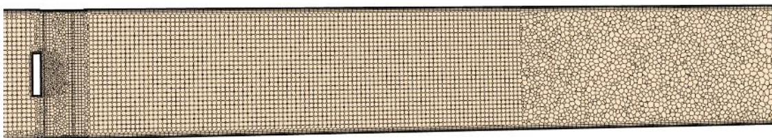
Obr 76 Síť oblasti před rotorem - metoda tlakového spádu
