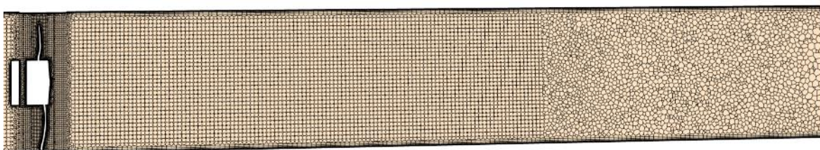
Obr 77 Síť oblasti před rotorem - MRF a ROT
