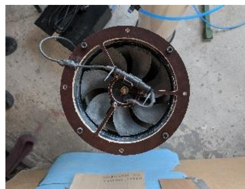
Obr 42 Uchycení ventilátoru v trati
