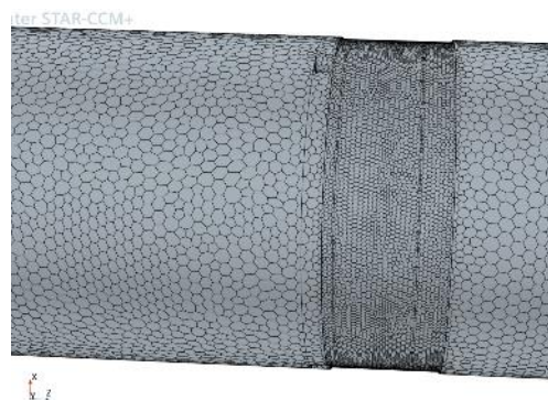
Obr 82 Povrchová síť - MRF a ROT
