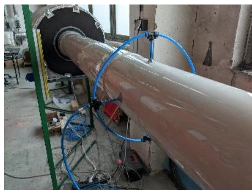
Obr 48 Tlakový odběr celkový pohled
