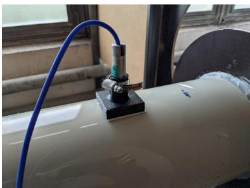
Obr 49 Detail uchycení anemometru
