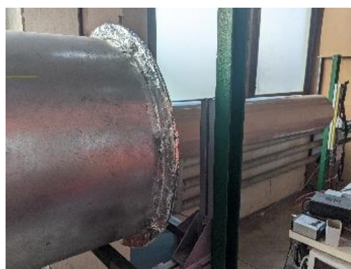
Obr 44 Přechod na průměr 500 mm
