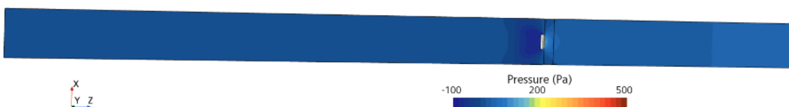
Obr 87 Tlakový spád - průběh tlaku - 12 m/s
