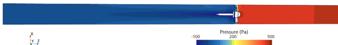
Obr 91 MRF - průběh tlaku - 12 m/s
