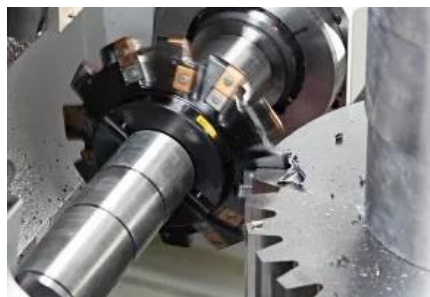
Obrázek 22 Výroba ozubení kotoučovou frézou dělicím způsobem [26]
