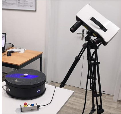
Obrázek 66 Poloha pro skenování ozubených kol
