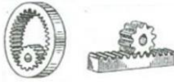
Obrázek 11 Převod s vnitřním ozubením a ozubeným hřebenem [13]
