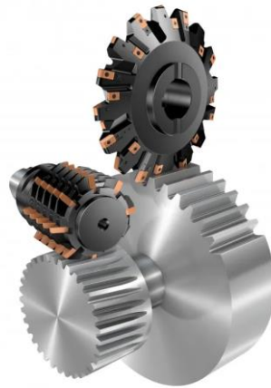
Obrázek 21 Frézování ozubení dělicím a odvalovacím způsobem [26]
