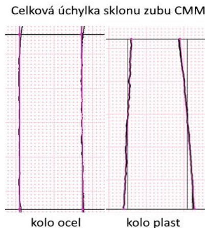
Obrázek 82 Porovnání celkové úchylky sklonu zubu ocelového a plastového kola (měřítko 250:1)
