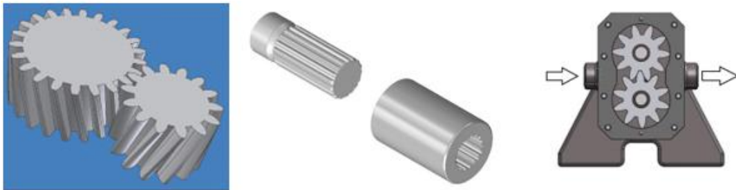
Obrázek 1 Ozubený převod, drážkování, zubové čerpadlo [1] [2] [3]
