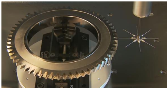
Obrázek 52 Měření ozubení na CMM bez RT [49]
