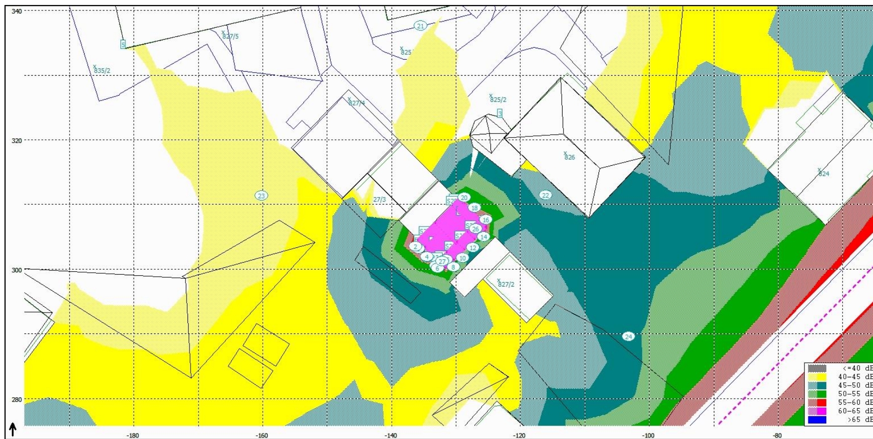
Obr. 25 Zobrazení hlukových pásem v simulačním programu 3 m nad zemí s vlivem silnice
