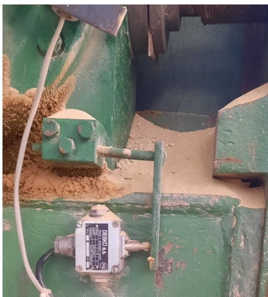
Obrázek 6.7: Bezpečnostní vypínač při přestřižení plechu
