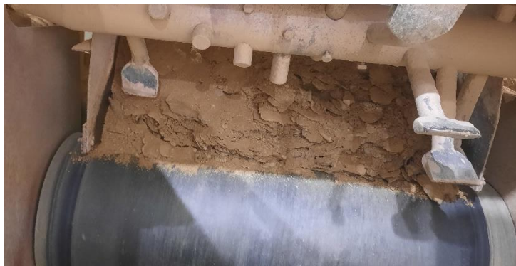
Obrázek 6.8: Drcený materiál v bufferu před mísičem
