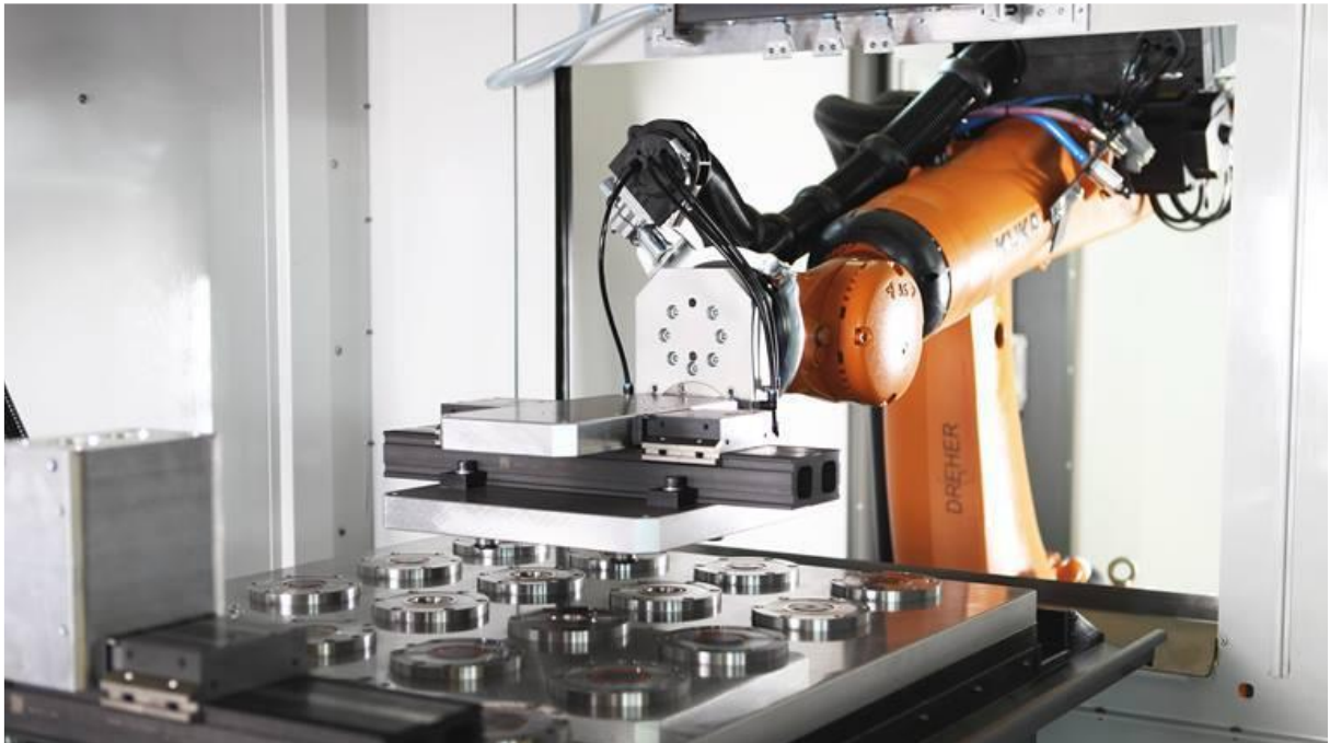
Obrázek 21 - Robot KUKA KE QUANTEC, který manipuluje s paletami [23]
