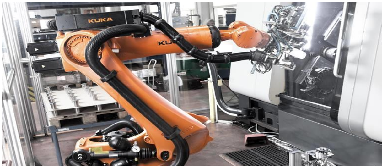
Obrázek 19 - Robot KUKA KR QUANTEC manipuluje s obrobky [24]
