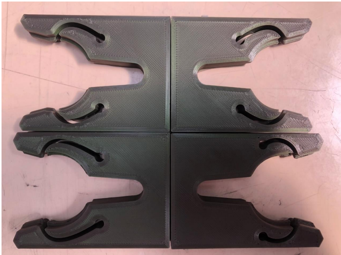
Obrázek 33 - Další verze end effectoru vytisknuté pomocí 3D tiskárny
