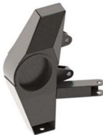
Obrázek 16 Původní těhlice studentské formule vyrobená technologií svařování [24]
