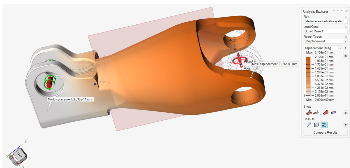
Obrázek 44 Analýza součásti, rozložení deformací
