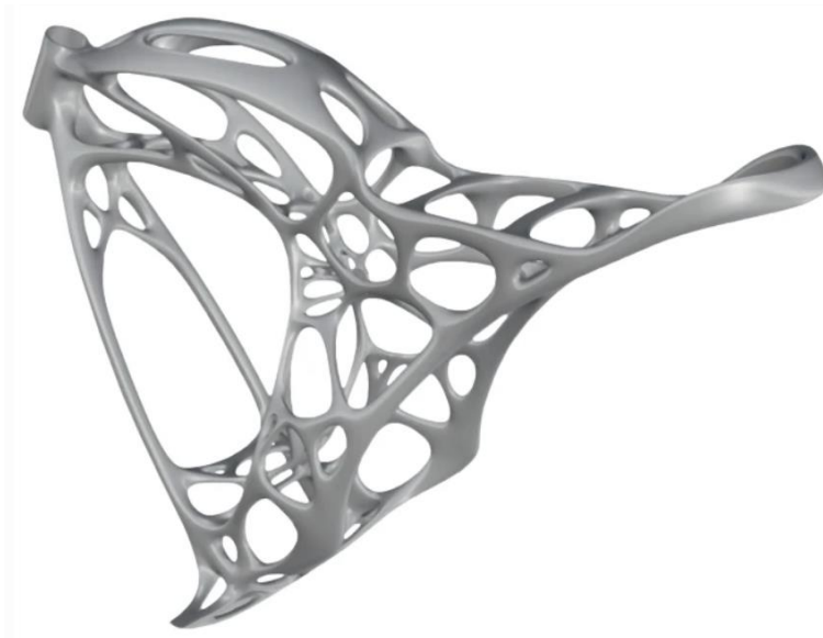
Obrázek 30 Light Rider – rám po vyhlazení výsledků topologické optimalizace [30]
