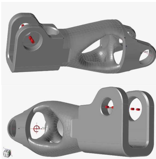
Obrázek 47 Varianta 2 - optimalizace s vnitřním objemem, kritérium Max. Stiffness
