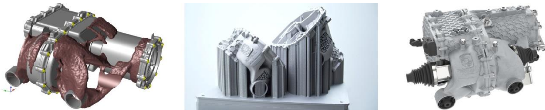
Obrázek 21 Vlevo topologická optimalizace skříně, uprostřed výtisk součástí, vpravo zkompletovaná skříň pohonu [26]
