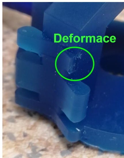
Obrázek 125 deformace po pádové zkoušce dílu Základna-P3-V2
