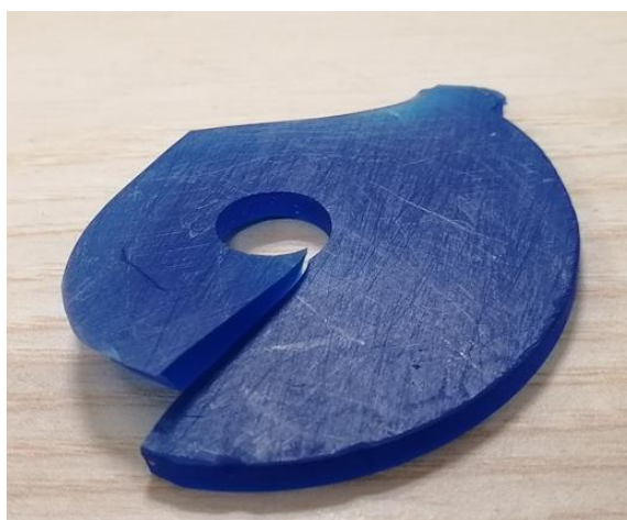
Obrázek 123 prasklina Základny P3
