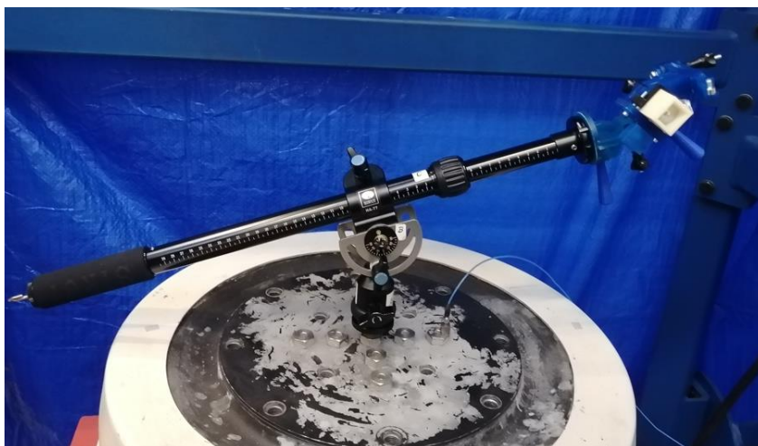
Obrázek 131 instalace celku na shakeru – Test 2
