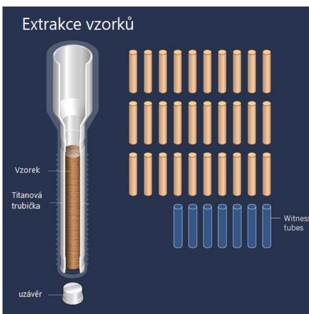
Obr. 17: Schéma nádobek na extrakci vzorků a witness tubes, které jsou součástí Preseverances Rover, přepracováno dle [24]
