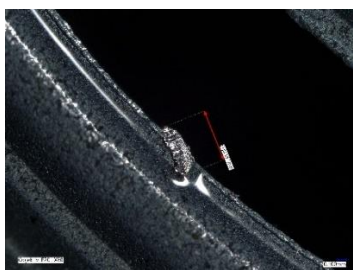
Obr. 54: Měření rozměrů kontaminace pomocí ručního výběru 2 bodů
