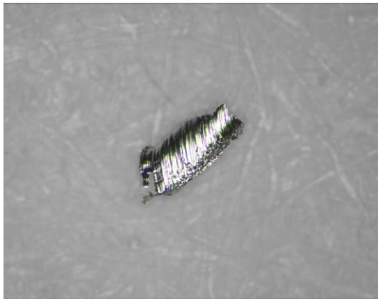
Obr. 1 Hliníková částicová kontaminace z víčka nádoby [8]
