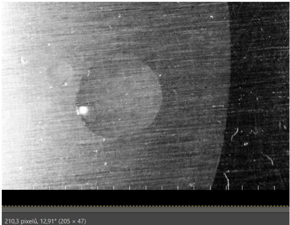
Obrázek č. 61 – Kapka demineralizované vody na oxidovaném hliníkovém povrchu s plošnou koncentrací oleje 0,587 [g.m -2 ]
