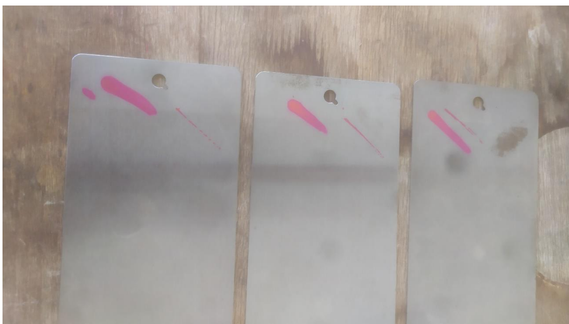
Obrázek č. 43 – Čisté ocelové Q-panely – inkoust s povrchovým napětím 36 – celistvý, inkoust s povrchovým napětím 40 – roztrhaný nebo alespoň shluklý do užší stopy
