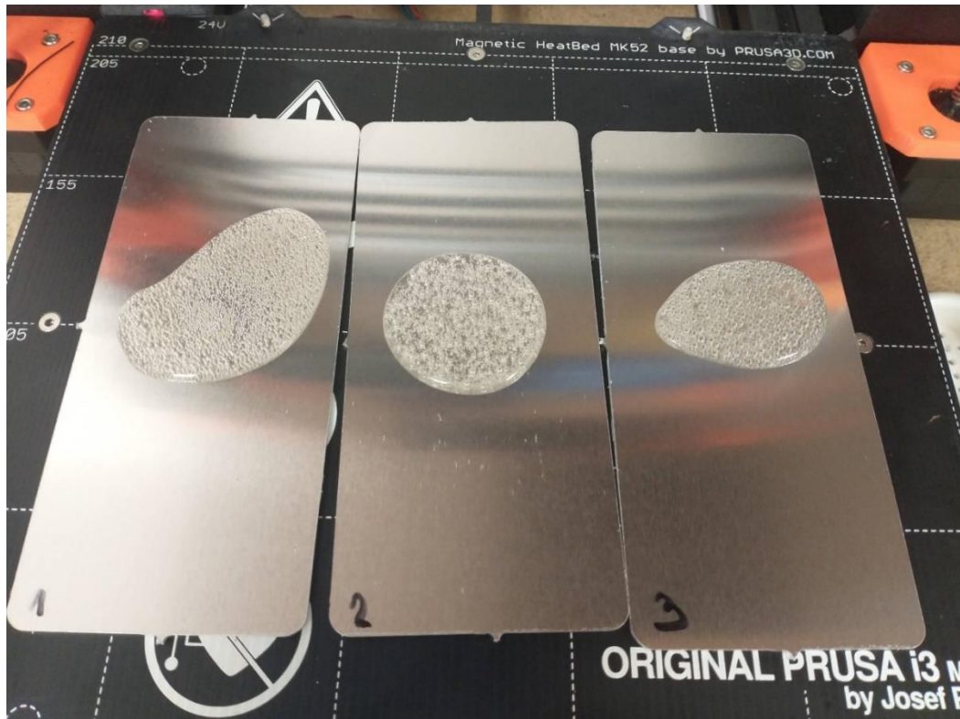
Obrázek č. 28 – Příprava oxidovaných ploch na hliníkových panelech 1
