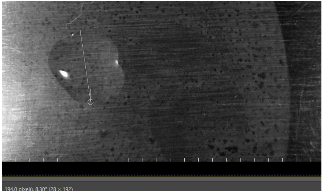
Obrázek č. 60 – Kapka demineralizované vody na oxidovaném hliníkovém povrchu
