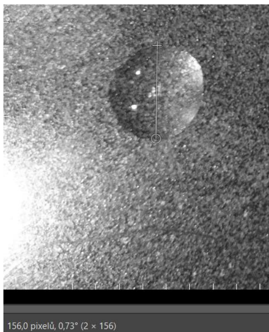
Obrázky č. 55 a 56 – Nalevo odmaštěný zinkovaný povrch, napravo povrch s plošnou koncentrací 0,555 g.m -2
