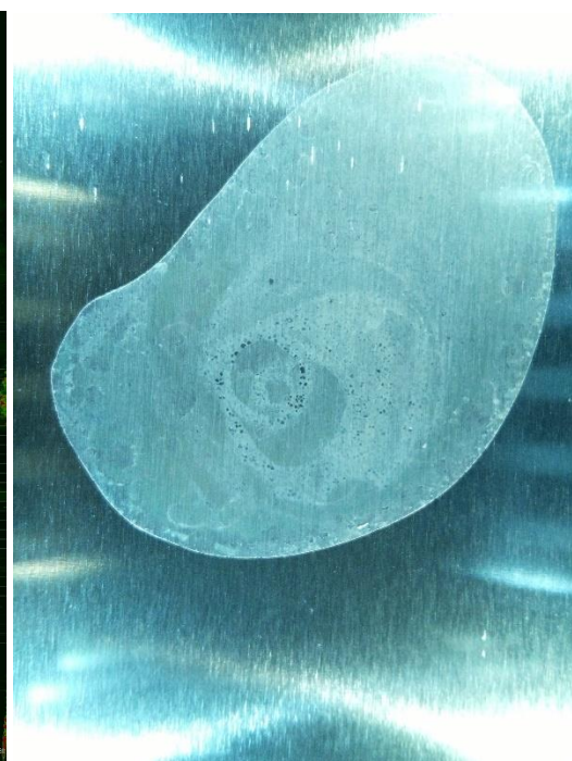
Obrázky č. 30 a 31 – Oxidovaný povrch hliníku a jeho fluorescence – vzorek č. 1
