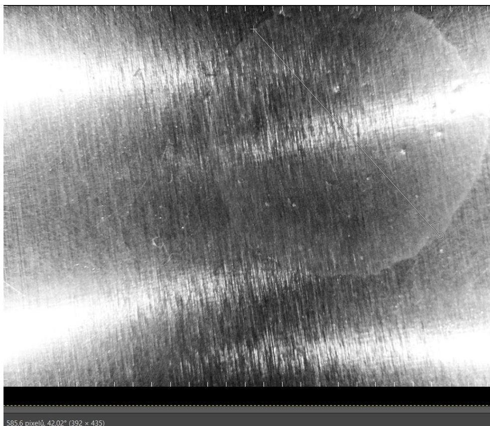
Obrázek č. 59 – Kapka isopropylalkoholu na Al povrchu s plošnou koncentrací oleje 0,587 [g.m -2 ]
