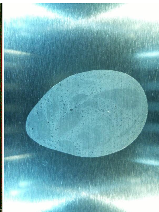
Obrázky č. 34 a 35 – Oxidovaný povrch hliníku a jeho fluorescence – vzorek č. 3
