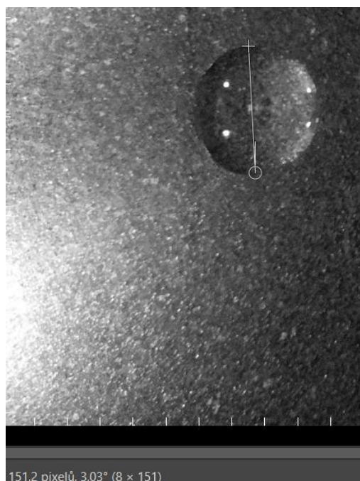
Obrázky č. 55 a 56 – Nalevo odmaštěný zinkovaný povrch, napravo povrch s plošnou koncentrací 0,555 g.m -2
