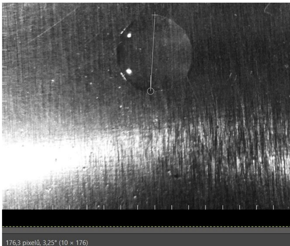
Obrázek č. 58 – Kapka demineralizované vody na Al povrchu s plošnou koncentrací oleje 0,587 \text{ [g.m}^{-2}\text{]}
