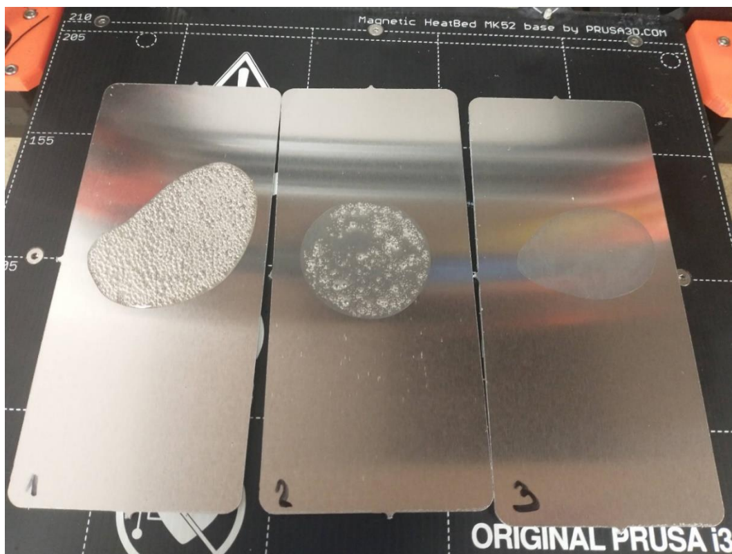
Obrázek č. 29: Příprava oxidovaných ploch na hliníkových panelech 2
