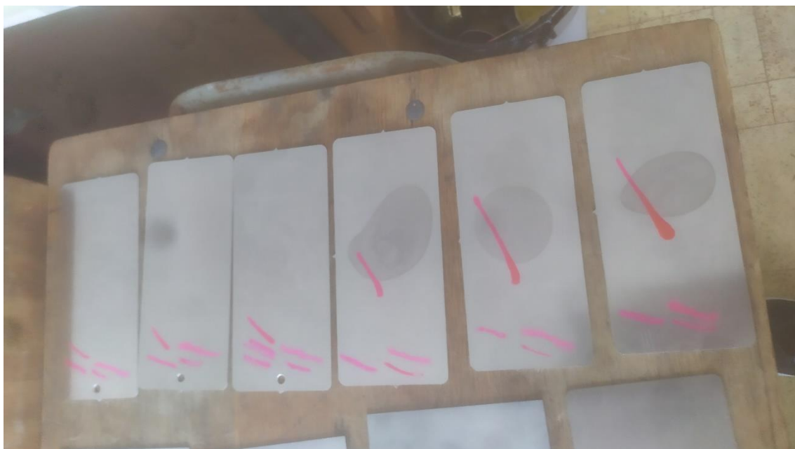
Obrázek č. 42 – Postupné nanášení inkoustů o různém povrchovém napětí
