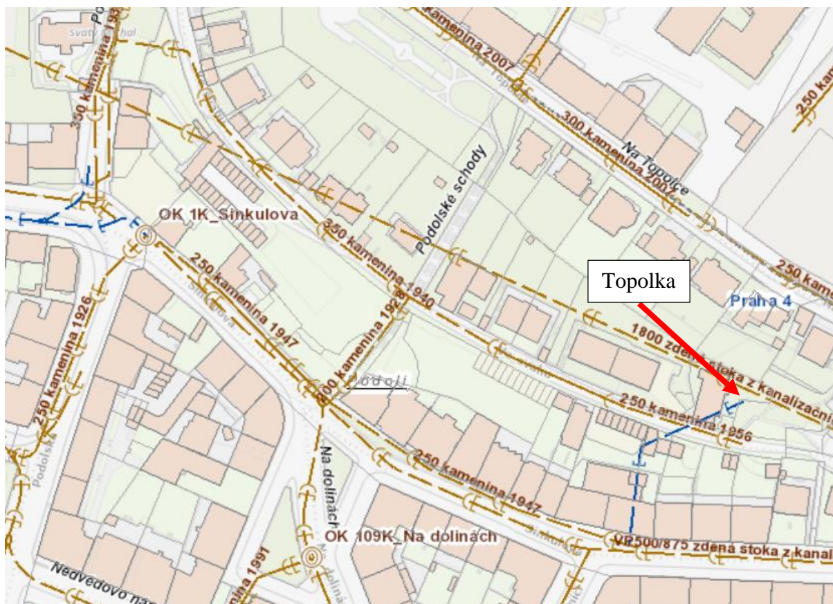
Obrázek 43 – Kanalizační síť v lokalitě
