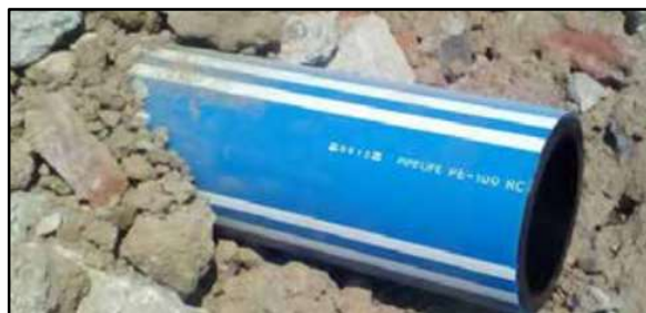
Obrázek 23: Příklad potrubí z PE [11]
