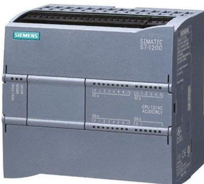
Obrázek 1.2 Monolitická architektura PLC [14] (upraveno).
