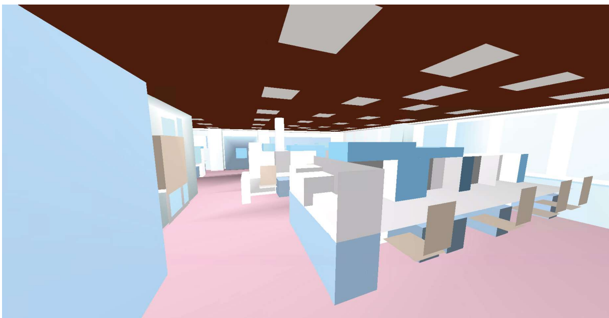
Obr. 41: Výpočtový model kanceláře č. 2 v programu Odeon [30] s barevným zobrazením pohltivosti ploch
