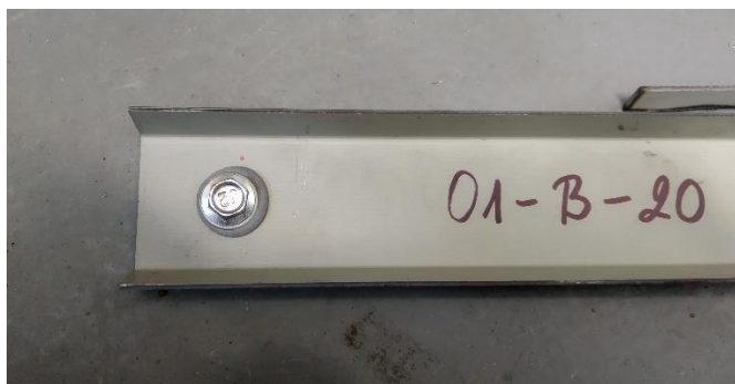
c) trapézový plech se zbylou hlavou šroubu – horní pohled
