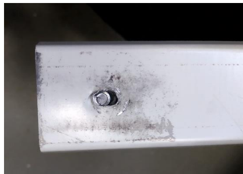
d) otláčený trapézový plech – shodní pohled
