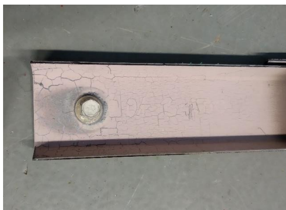
c) trapézový plech se zbylou hlavou šroubu – horní pohled
