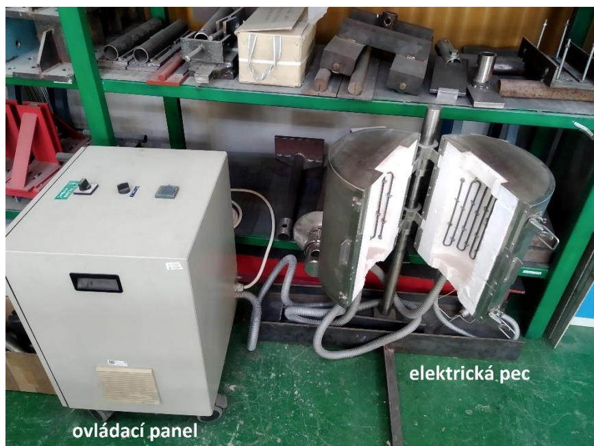
Obrázek 39: Elektrická pec Elsklo OCEP RH1 s ovládací panelem
