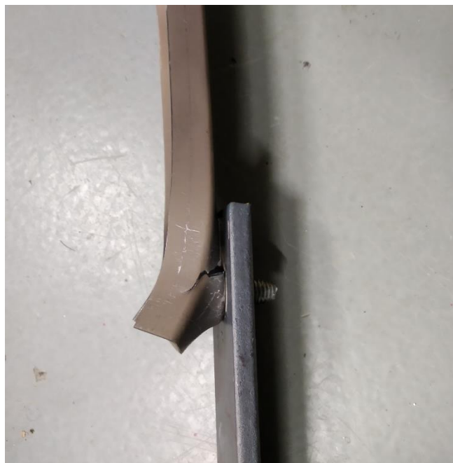
Obrázek A11: Zkušební vzorek 01-A-300 před a po zkoušce
