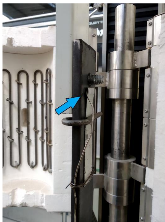
b) termočlánek upevněný v místě šroubu
