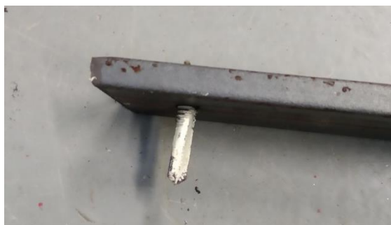
a) horní pásnice vaznice se zbylým dříkem – boční pohled
