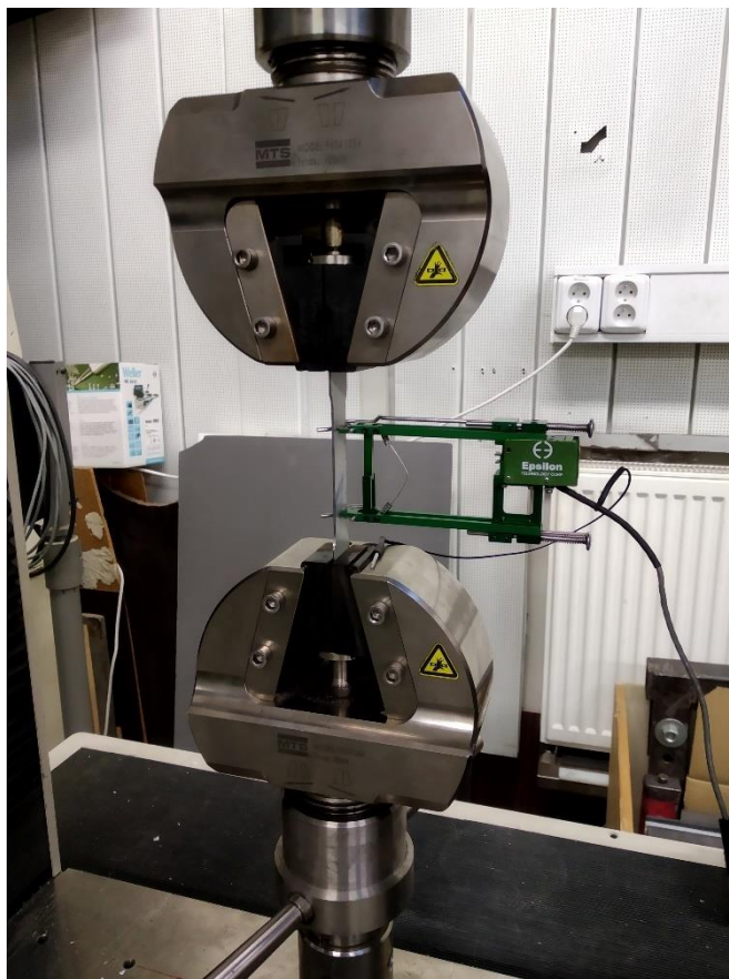
Obrázek A31: Zkušební sestava pro materiálové zkoušky
