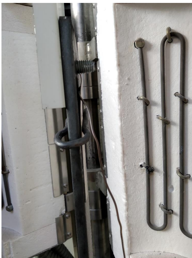
Obrázek A7: Zkušební sestava při zvýšených teplotách – umístěný termočlánek
