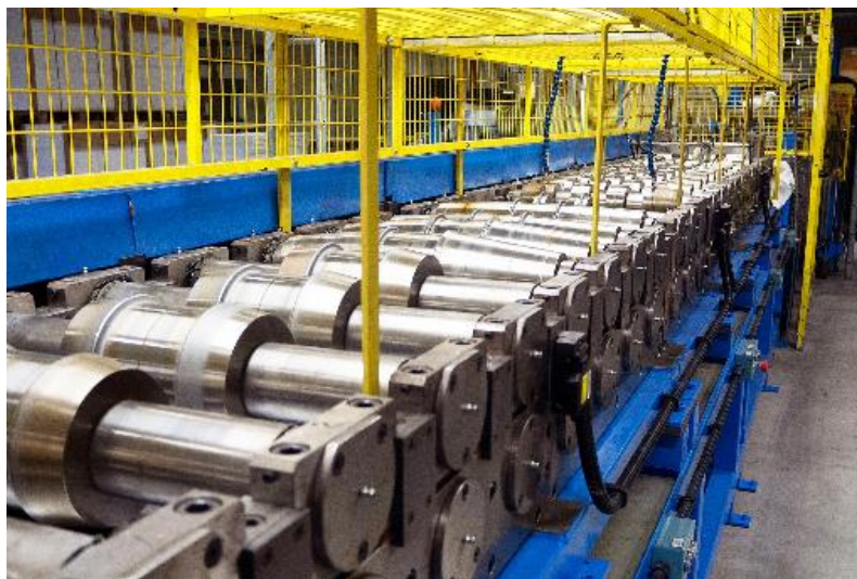
Obrázek 3: Profilování – válcovací linka s otáčivými válci
