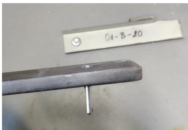
a) horní pásnice vaznice se zbylým dřívkem – boční pohled
