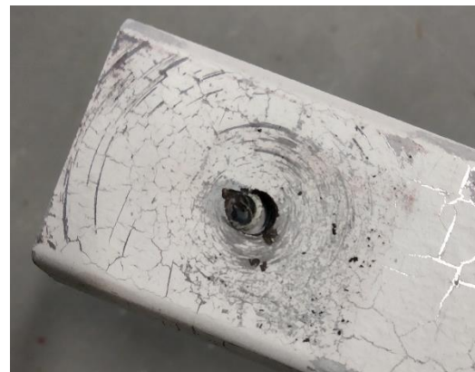
d) otláčený trapézový plech – shodní pohled
