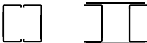
Obrázek 8: Složené uzavřené průřezy [6]
