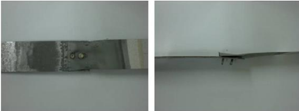
Obrázek 35: Šroubový přípoj při teplotě 594 °C [37]
