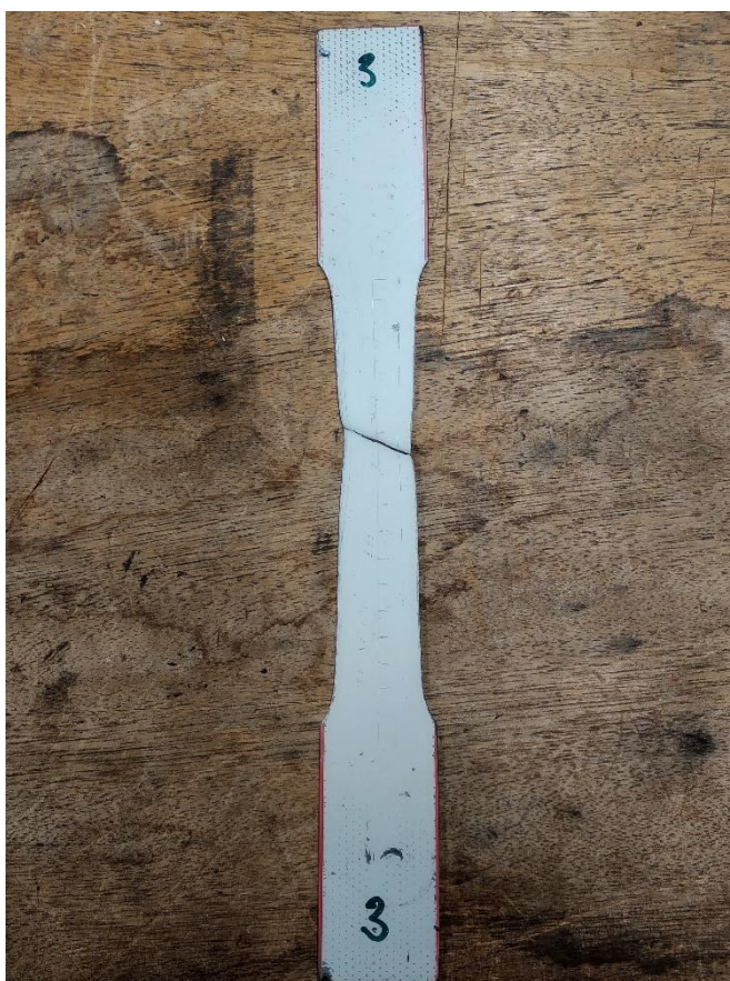
Obrázek A30: Zkušební vzorky po zkoušce
