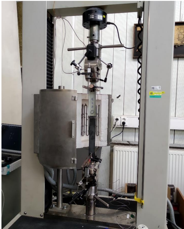
Obrázek A1: Zkušební sestava při běžné teplotě – přední pohled
