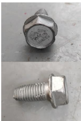
a) samořezný závitotvorný šroub (Ø závitů 10,6 mm)
