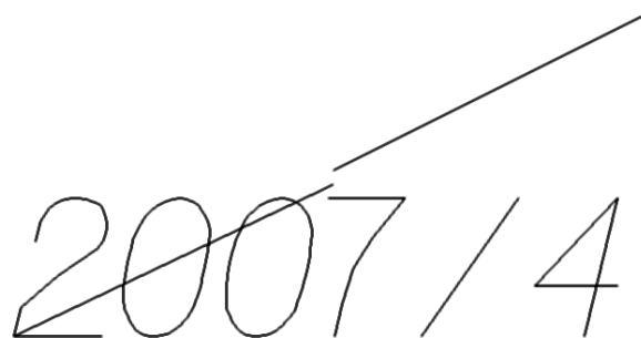
Obrázek 5.5: Čára a šipka nejsou napojeny. Běžná chyba, kdy souřadnice koncového bodu šipky nejsou zcela shodné se souřadnicemi umístění šipky.
