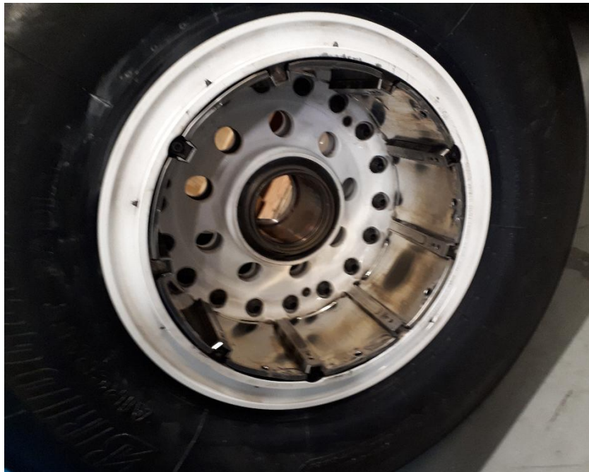
Obr. 10: Kolo PN C20195162 (vnitřní strana) – první PN ze seznamu nejčastěji opravovaných dílů na ULC-KO v roce 2015 a 2021 (vlastní zpracování/CSAT)
