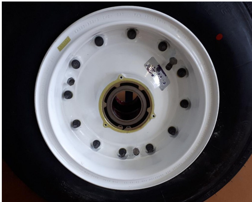
Obr. 11: Kolo PN C20195162 (vnější strana) – druhý PN ze seznamu nejčastěji opravovaných dílů na ULC-KO v roce 2015 a 2021 (vlastní zpracování/CSAT)
