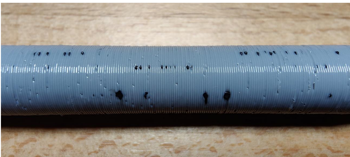
Obrázek 17: Detail na proraženou průchodku třetí sady
