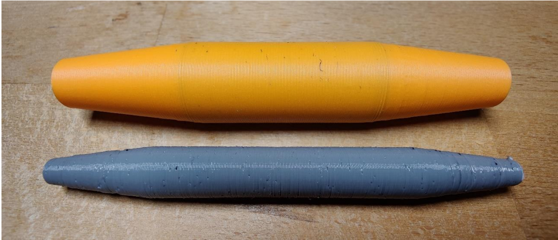
Obrázek 18: Porovnání tloušťky průchodek první a druhé sady (nahore) a průchodek třetí sady (dole)
