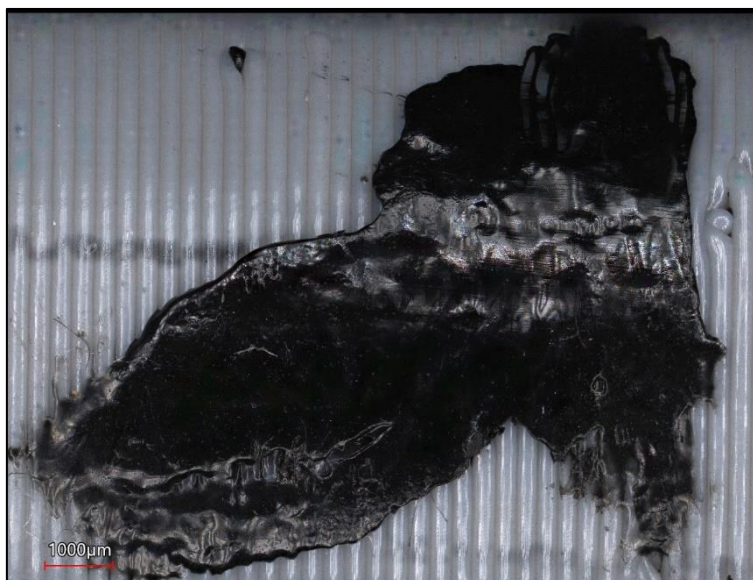
Obrázek 21: Detail na místo průrazu průchodky šesté sady
