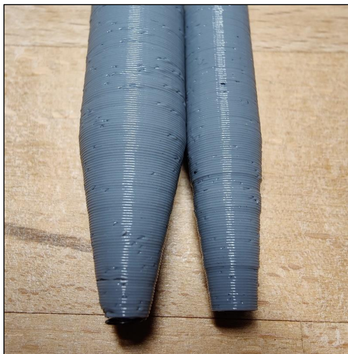
Obrázek 24: Porovnání tloušťky průchodky šesté sady (vlevo) a páté sady (vpravo)
