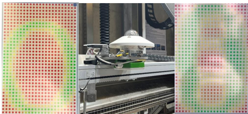
Obrázek 38: Homogenita ozáření před kalibrací (vlevo) a výsledná (vpravo), pyranometr (uprostřed)
