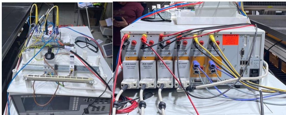
Obrázek 42: Experimentální rozvaděč (vlevo) a zapojení kanálů Zimmer (vpravo)
