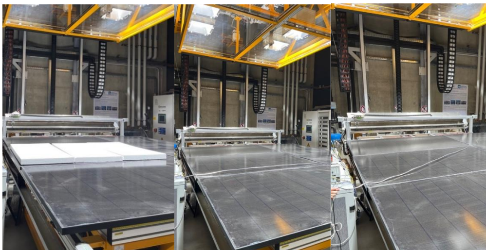
Obrázek 39: Ukázka plného zastínění polystyrenem, drát podélně, drát šikmo
