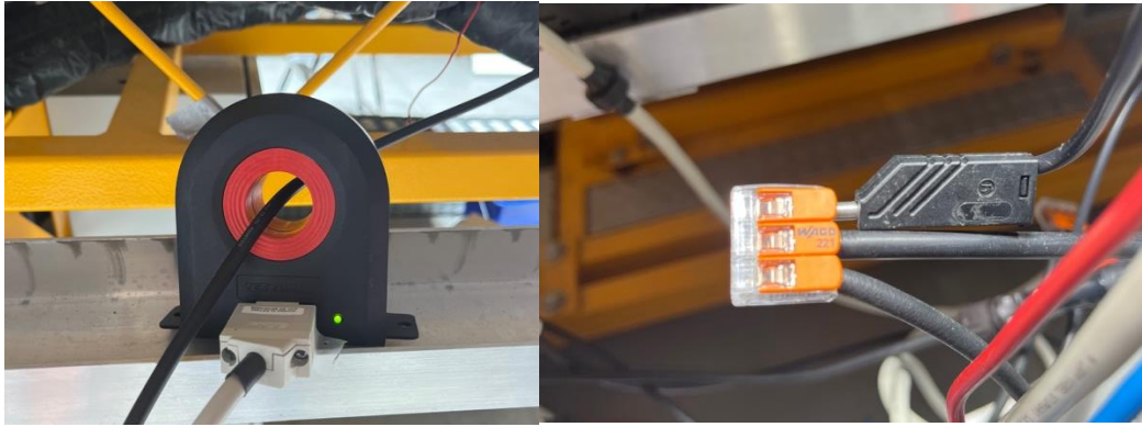
Obrázek 41: Měření proudu (vlevo) a napětí jednoho pólu (vpravo)
