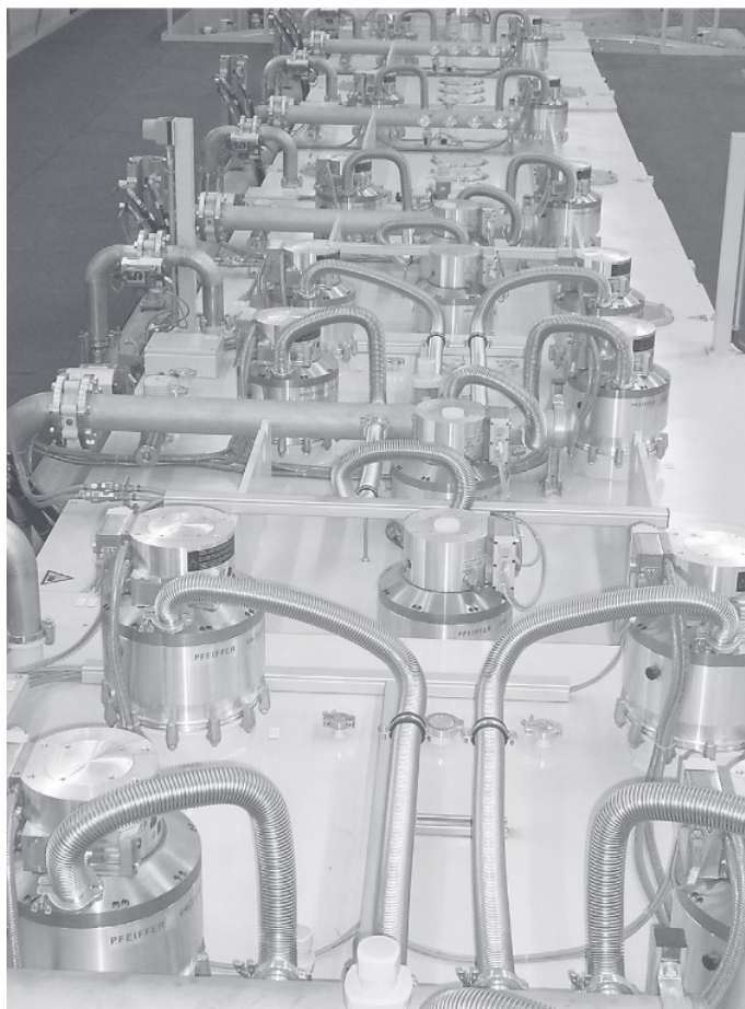
Obrázek 3.2. Průmyslové použití turbomolekulárních vývěv, převzato z [3]
